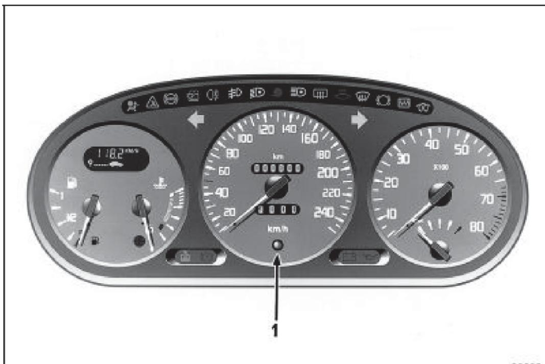
1 Кнопка установки на нуль счетчика пробега за поездку
