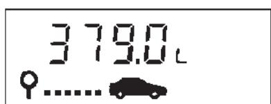
максимальная емкость экрана дисплея: **999 л или галлонов\***.
