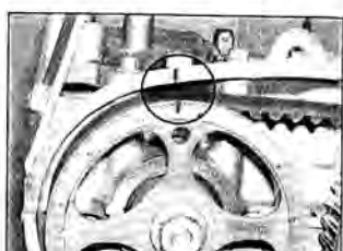
Рис. 3.35. Нанесите метки совмещения на звездочку и верхнюю секцию головки цилиндров
