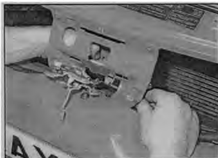
Рис. 10.3,б. ... и снимите замок, отцепив его от оболочки троса...
