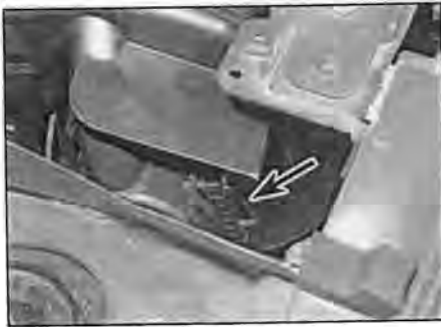
Рис. 9.32 На некоторых моделях требуется отсоединить проводку модуля управления от мотора (разъем указан стрелкой), освободив защелки, снимите модуль
