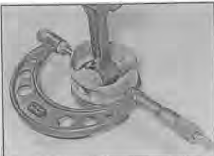
Рис. 15.11,а. Измерение диаметра поршня
