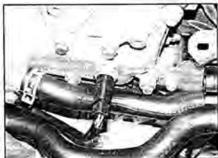
Рис. 9.71 Датчик температур на корпусе термостата (двигатель K4M)
