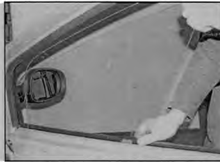
Рис. 14.7 Выньте стекло через проем
