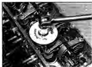
Рис. 9.86.а. Поворачивание болта с помощью угломерного инструмента
