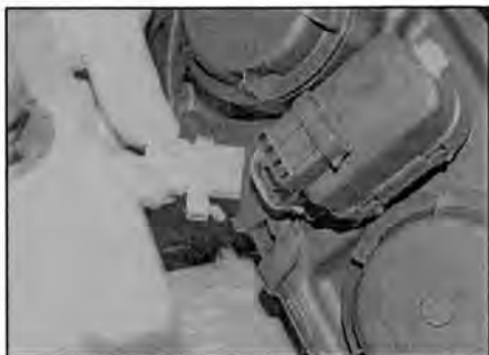
Рис. 7.3 На моделях с корректором фар отсоедините от мотора разъем проводки
