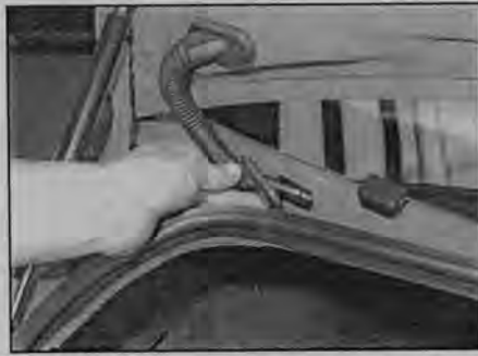
Рис. 15.9 ... освободите уплотнитель и выньте жгут проводки из кузова
