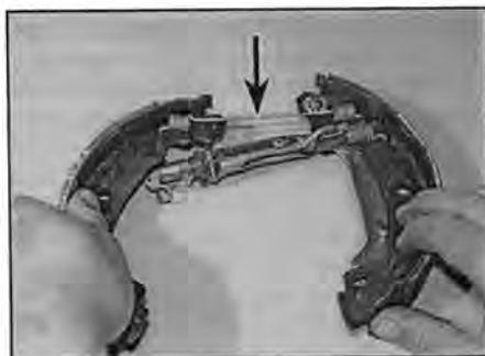
Рис. 5.10,б. ... выведите колодки из зацепления со стойкой и снимите верхнюю стяжную пружину (указана стрелкой)
