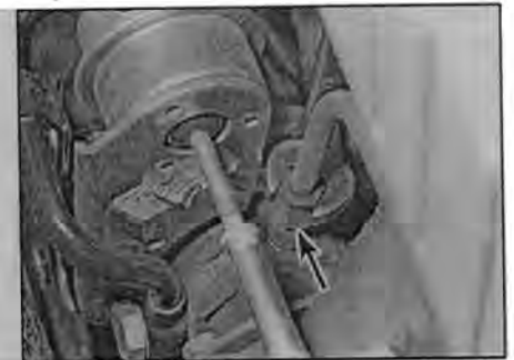
Рис. 30.18, а. Отверните гайку (указана стрелкой) питающего маслопровода турбоагнетателя
