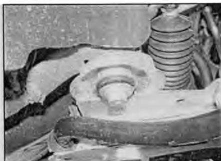
Рис. 8.30,б. ... отверните болты крепления...
