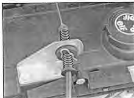
Рис. 3.8 Регулировочный червяк троса акселератора и кронштейн
