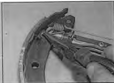
Рис. 5.10,а. Отцепите пружину регулировочной стойки от передней колодки...
