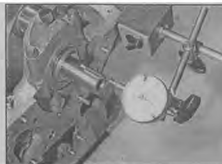
Рис. 13.3 Проверка осевого зазора коленвала индикатором часового типа
