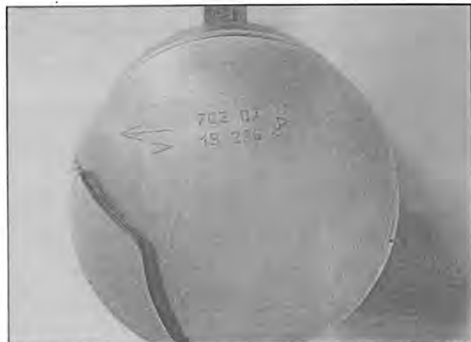
Рис. 20.14,а. Метки на днище поршня – двигатели K7M/K4J/K4M
