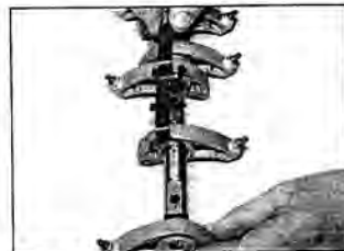
Рис. 8.8 При необходимости рокеры можно снять с вала, но сложите их по порядку
