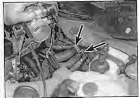
Рис. 9.37 Ослабьте хомуты и отсоедините шланги охлаждения (указаны стрелками) от штуцеров радиатора отопителя
