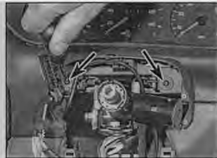
Рис. 16.6 Отверните винты (указаны стрелками) крепления лицевой панели к рулевой колонке
