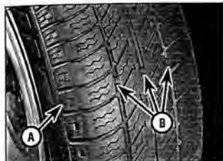
Глубина рисунка протектора – визуальная проверка
