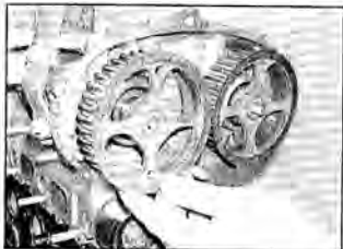
Рис. 4.4 Для доступа к сальнику необходимо снять соответствующую звездочку
