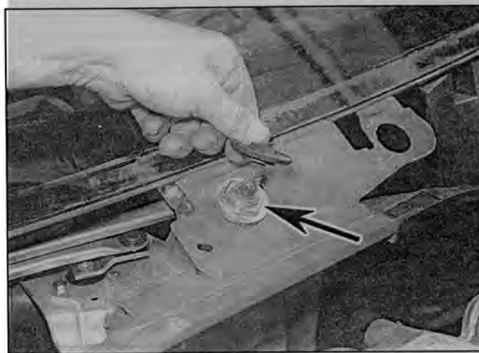
Рис. 16.17,а. Снимите резиновые заглушки, отверните гайки шпинделя (указана стрелкой) и снимите шайбы - Megane
