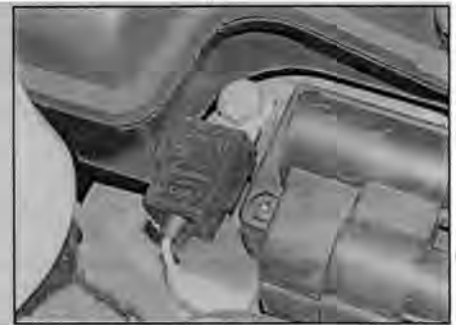
Рис. 3.5 Подавитель помех крепится одним из винтов
