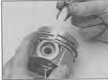
Рис. 15.2 Снятие поршневых колец с помощью щупа
