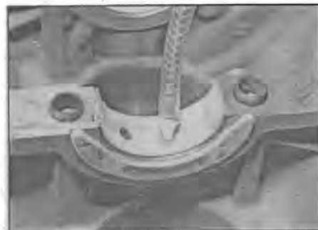
Рис. 19.16 Смажьте вкладыши перед установкой крышек
