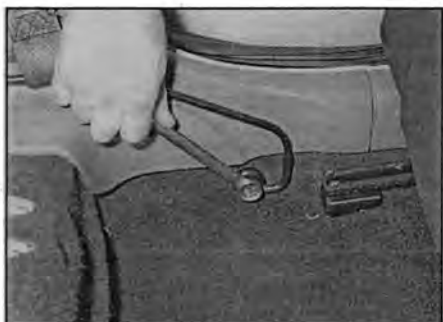
Рис. 27.13,а. На моделях купе отверните болт крепления...
