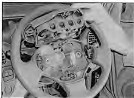
Рис. 25.3 Снимите водительскую подушку безопасности и отсоедините ее разъем проводки
