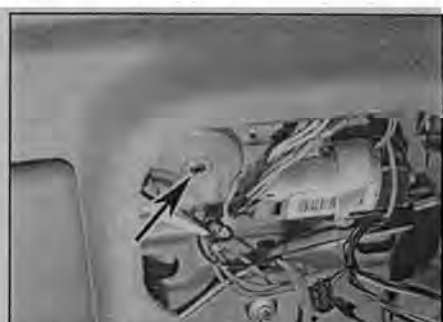
Рис. 23.2 При необходимости открыть люк можно, вращая шпindel мотора шестигранником
