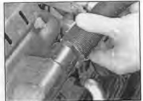
Рис. 2.2,а. Отсоедините от щитка гофрированный патрубок (двигатели Е7J)
