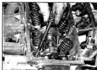
Рис. 9.41.в. Снимите болты крепления головки
