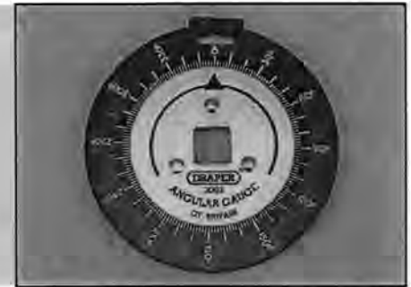
Индикатор угла затяжки соединений (угломерная насадка)
