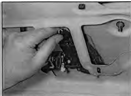
Рис. 16.6 ... и отсоедините разъем проводки мотора центрального замка
