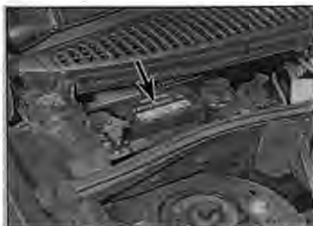
Рис. 4.1 Место для установки аккумулятора под капотом на моделях Megane
