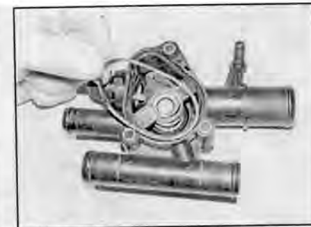
Рис. 4.6 Снимите уплотнительное кольцо корпуса термостата
