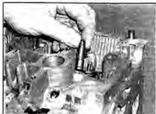
Рис. 8.37 Выньте гидротолкатели и разложите их в контейнер с маслом по порядку
