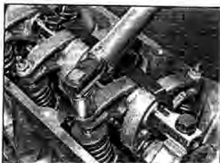
Рис. 4.8.в. Затяните контргайку предписанным моментом
