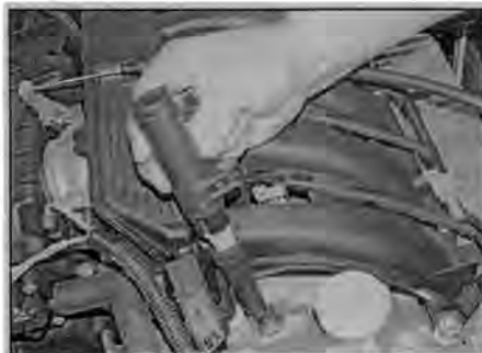
Рис. 3.7,б. ... и снимите катушку со свечи зажигания
