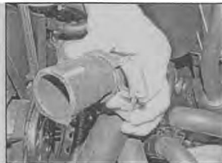
Рис. 6.64,а. Самодельный "инструмент" для снятия пружинных хомутов
