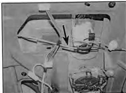
Рис. 18.3 Отсоедините тягу от кнопки замка...
