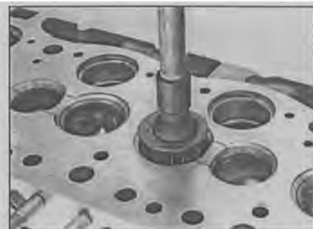
Рис. 9.16 Притирка седла клапана – поднимайте клапан для перемещения пасты
