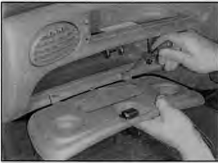
Рис. 28.7 ... и аккуратно открепите петли крышки от лицевой панели
