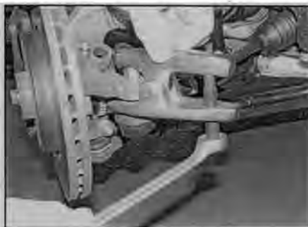
Рис. 17.2 Для отсоединения рулевого наконечника требуется съемник
