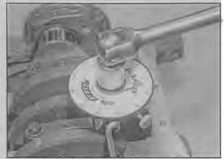
Рис. 19.18,б. ... и доворачивайте на предписанные углы
