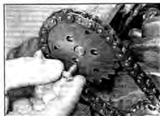
Рис. 11.5.б. Отверните болты крепления звездочки масляного насоса
