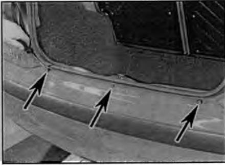
Рис. 7.1,а. Отверните три верхних винта крепления бампера (указаны стрелками)
