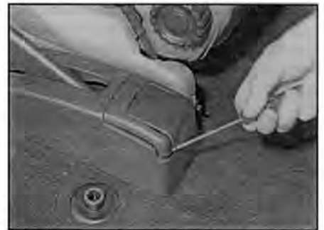
Рис. 29.3 На моделях с механическими задними стеклоподъемниками открепите пепельницу в задней части центральной консоли
