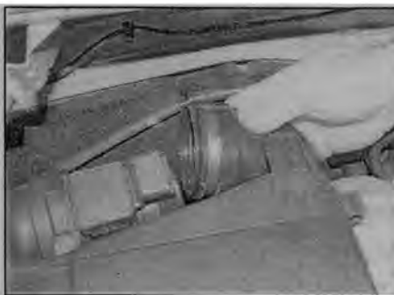
Рис. 2.11,б. Отсоедините от ДМРВ воздуховод турбонагнетателя
