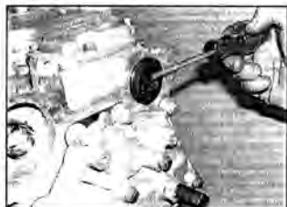
Рис. 3.13 Поддев отверткой, выньте колпачки распределов, установленные в левой части головки цилиндра
