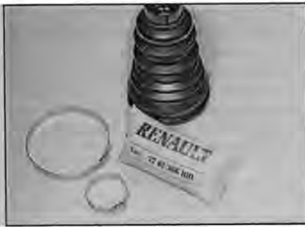
Рис. 3.19 Ремкомплект чехла приводного вала "Renault"
