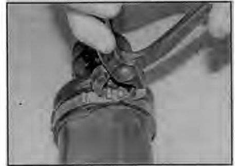
Рис. 4.18 Кусачками сдавите выступающую часть хомута
