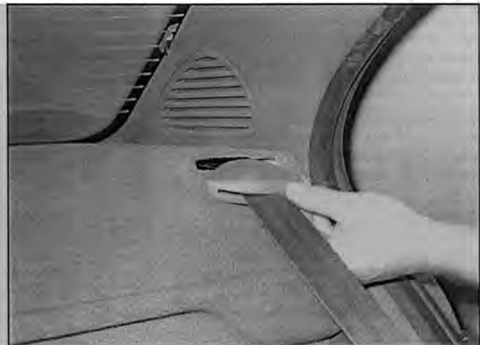
Рис. 27.52 На моделях седан открепите крышку ремня с накладки задней полки
