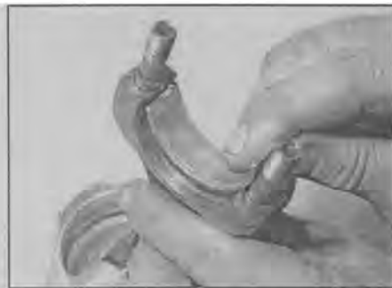
Рис. 12.5 Снятие верхнего вкладыша с крышки шатунных подшипников
