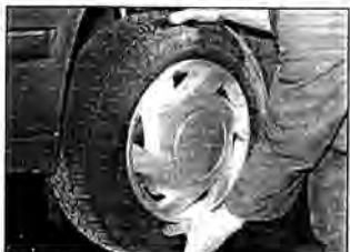
Рис. 7.4 Ухватив колесо руками, как здесь показано, и покачивая его, проверьте износ ступичных подшипников
