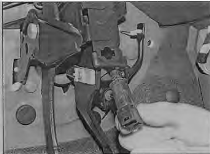
Рис. 18.2,б. ... и выверните датчик включения стоп-сигналов (для ясности лицевая панель снята)
