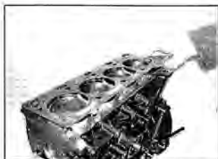
Рис. 9.130. Уложите новую прокладку на блок цилиндров...
