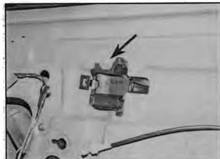
Рис. 14.12.а. Отверните верхний болт крепления (указан стрелкой)
