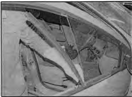
Рис. 14.14,б. ... и разверните направляющий желоб на 90°, чтобы снять его
