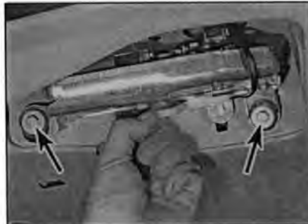
Рис. 17.4. На моделях купе отсоедините проводку и отверните болты крепления (указаны стрелками). Снимите мотор
