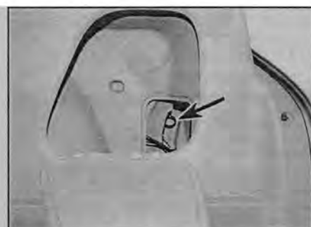
Рис. 19.11 Чтобы освободить лючок заливной горловины, потяните за кольцо (указано стрелкой) – Scenic
