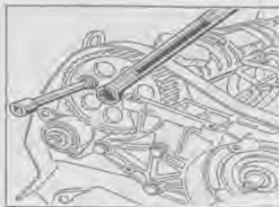
Рис. 6.24.а. Торцевым ключом, нажав его на болт крепления задней крышки, удерживайте звездочку от проворачивания
