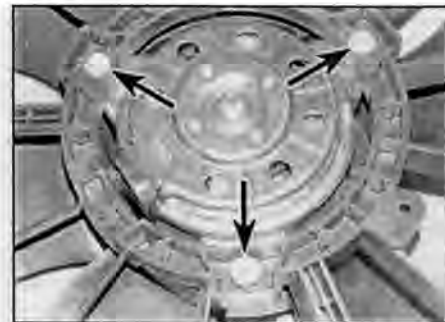
Рис. 5.11 Отверните три болта крепления (указаны стрелками)
