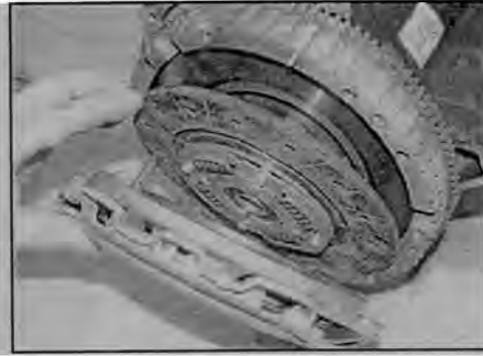
Рис. 4.4. Снятие нажимного и фрикционного дисков сцепления
