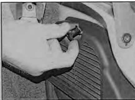
Рис. 5.22 На моделях хэтчбек (показан на рисунке) и седан отверните гайку и откройте заднюю крышку фонаря
