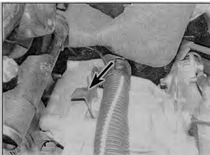
Рис. 8.37 Один из болтов крепления стартера крепит и кронштейн проводки
