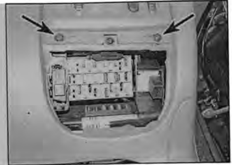
Рис. 4.13 Снимите крышку блока предохранителей и отверните винты крепления (указаны стрелками)
