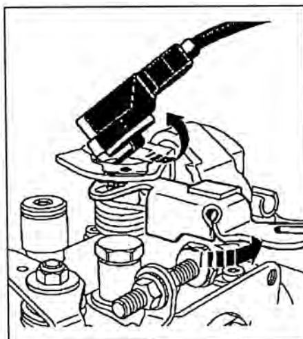
Рис. 17.5 Снятие потенциометра нагрузки (двигатель F8Q 788)
