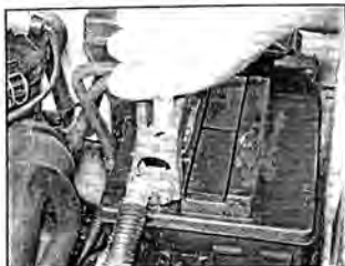
1 Присоедините один конец красного провода "прикуривателя" к положительному выводу разряженной батареи.
