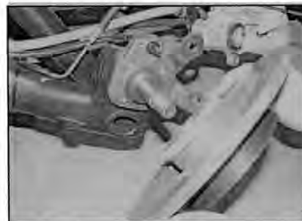
Рис. 25.7 Снимите диск со ступицы с оси
