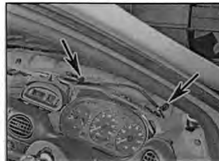
Рис. 9.3 На "праворульных" моделях открепите клипсы крепления троса управления замком капота, расположенные в верхней части моторного щита
