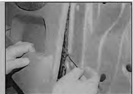
Рис. 12.15 Снимая панель, разрежьте герметик скальпелем
