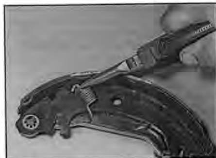
Рис. 5.10,г. ... и снимите пружину, помня, что она зацеплена коротким крючком за колодку
