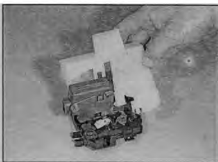
Рис. 19.2,б. ... открепите пластиковую крышку и снимите ее с замка двери
