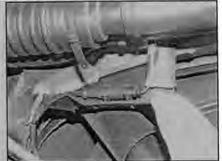
Рис. 12.2.б. Если предусмотрено, отсоедините разъемы датчиков ABS
