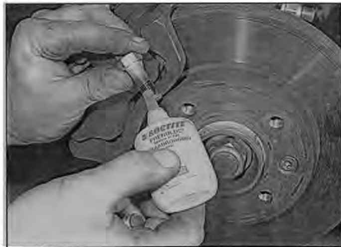
Рис. 2.16 На резьбовые части болтов крепления суппорта необходимо нанести анаэробный герметик
