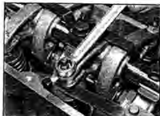
Рис. 4.8.а. Ослабьте контргайку нажимным ключом
