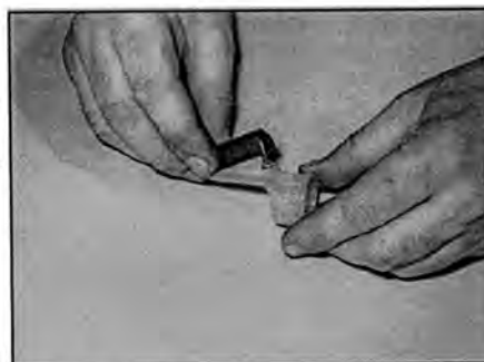
Рис. 6.19, а. Открепите крышку с обрамления прикуривателя...
