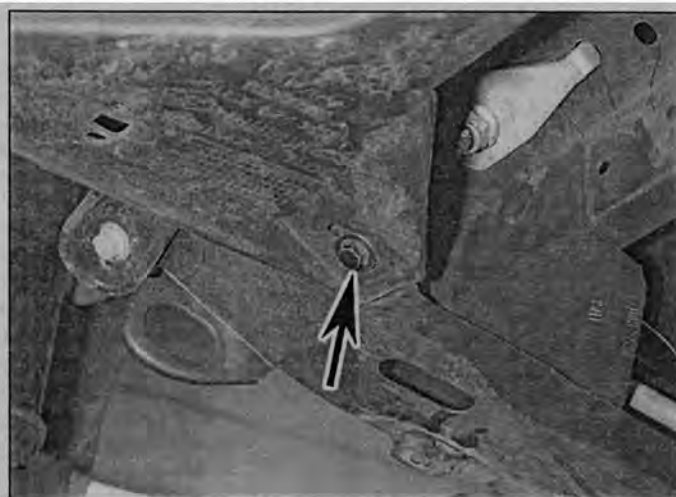
Рис. 6.4,б. ... и болты (указаны стрелками) крепления защитного кожуха силового агрегата к подрамнику
