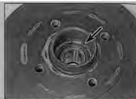
Рис. 9.4 Удалите стопорное кольцо (указано стрелкой)
