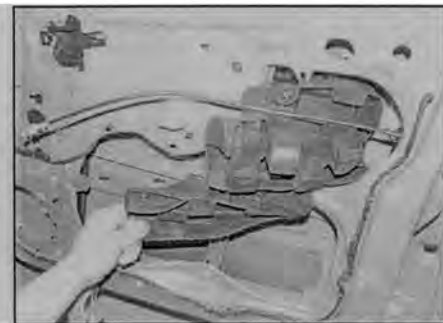
Рис. 13.7,а. Снимите противоугонную крышку с узла замка
