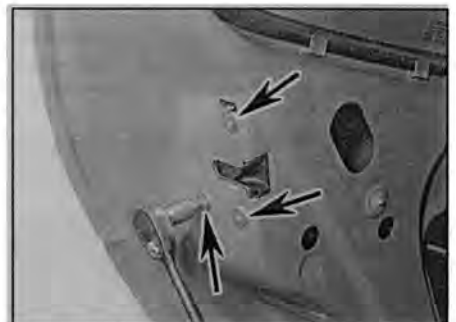
Рис. 13.18 Отверните винты крепления (указаны стрелками) и выньте узел замка из задней двери
