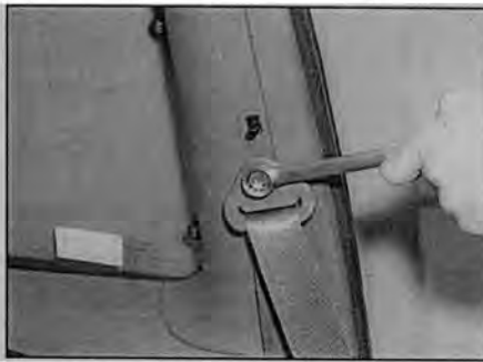
Рис. 27.18 ... Снимите заглушку и отверните болт верхнего крепления ремня
