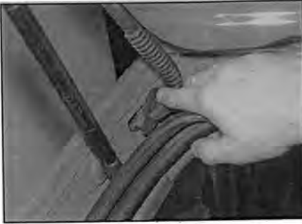
Рис. 17.3 Отсоедините разъем проводки пятой двери и вытяните проводку из кузова
