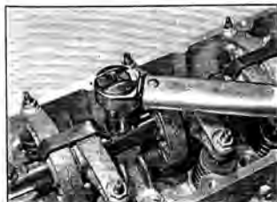
Рис. 8.15 Затяните болты крепления рокерного вала
