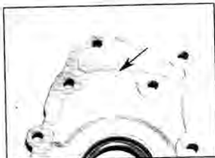
Рис. 9.14.б. ...так, чтобы герметик не попал в масляный канал (указан стрелкой) вверх корпуса
