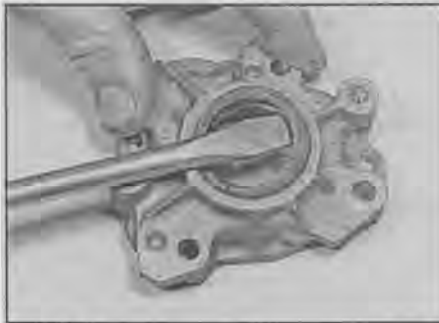
Рис. 11.10,а. Выньте сальник из корпуса
