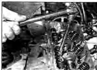
Рис. 9.41.б. Ослабьте болты крепления головки
