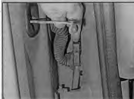
Рис. 11.3 Поднимите фиксатор и отсоедините разъем проводки двери
