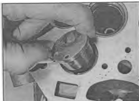
Рис. 9.5 Снимите форкамеру – двигателя F8Q
