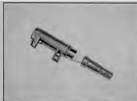
Рис. 3.7,в. Катушка зажигания, снятая с головки цилиндров
