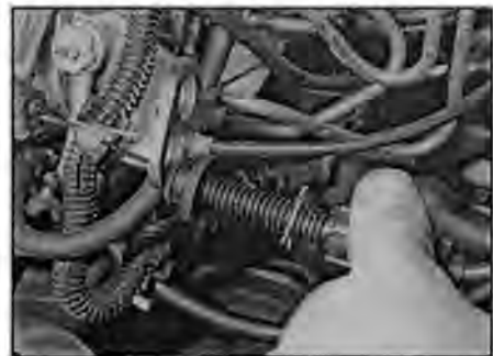
Рис. 5.2.б. ... Чтобы трос мог пройти через кронштейн (ранние насосы Lucas)
