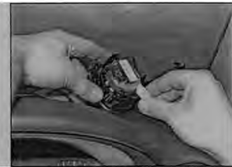
Рис. 20.2,б ... и снимите громкоговоритель, отсоединив от него разъем проводки
