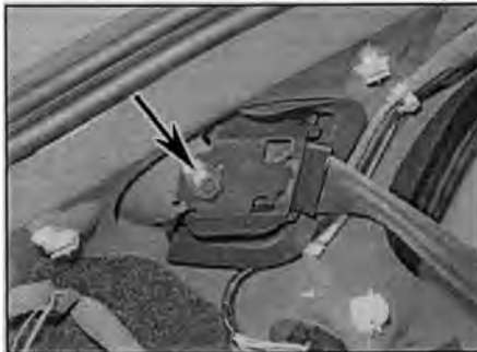
Рис. 27.43 Болт крепления (указан стрелкой) ремня заднего сиденья – хэтчбек
