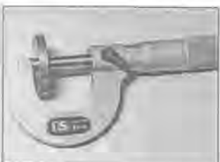
Рис. 4.10.б. Измерение толщины шайбы микрометром
