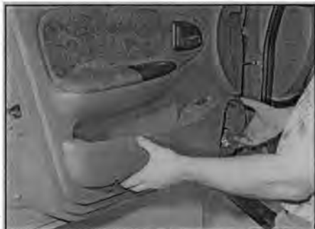
Рис. 12.4,б. ... открепите карман для карт и снимите его с двери...
