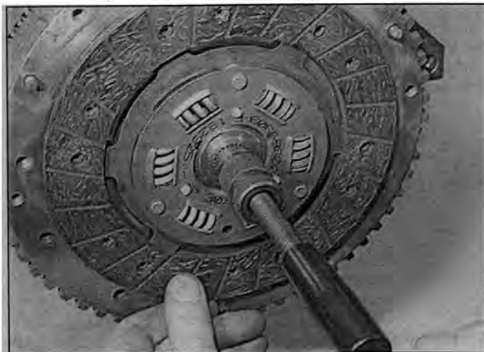
Рис. 4.13 Использование центрирующей оправки фрикционного диска
