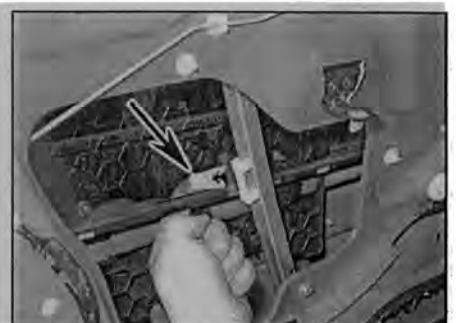
Рис. 14.5,б. ... и стяните фиксатор (указан стрелкой) со стеклоподъемника
