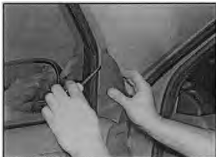
Рис. 12.2,а. Открепите внутреннюю накладку наружного зеркала и снимите ее с двери
