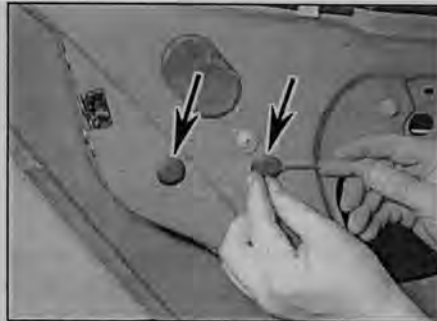
Рис. 13.13 Снимите заглушки (указаны стрелками) для получения доступа к гайкам крепления наружной ручки задней двери
