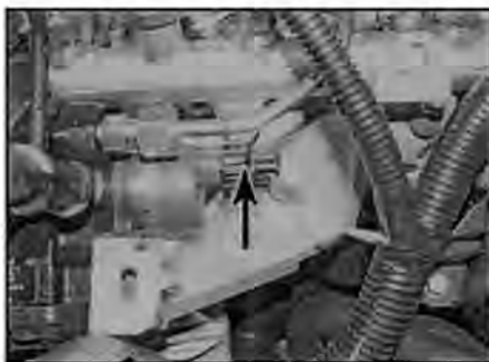
Рис. 23.11 Отсоедините проводку от датчика в задней части ТНВД
