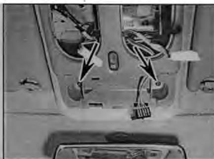
Рис. 4.35,а. отверните винты крепления (указаны стрелками) и открепите консоль, отсоединив разъемы проводки
