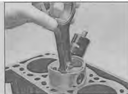
Рис. 15.13,а. Поршнем равномерно протолкните кольцо в цилиндр...
