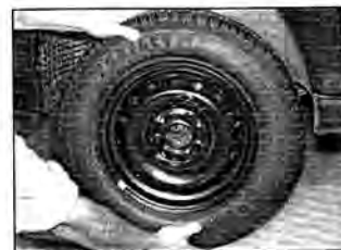
7 Отверните болты крепления колес и снимите колесо. Установите запасное колесо и заверните болты. Слегка затяните болты "баллонным" ключом и опустите автомобиль.
