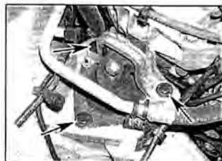
Рис. 3.10.б. ... и три болта (указаны стрелками) крепления резиновой опоры к кузову
