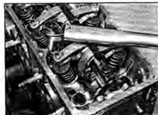
Рис. 9.86.б. Затяжка болтов крепления головки с помощью динамометрического ключа
