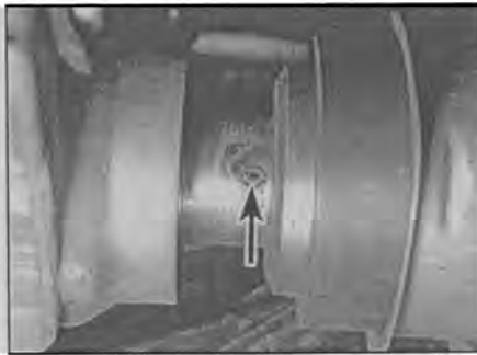
Рис. 4.15,а. Пружинный штифт (указан стрелкой) крепления приводного вала к выходному валу КПП (солнечной шестерне)
