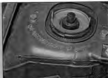
Рис. 4 Номер кузова выбит на стекле крепления верхней опоры передней подвески
