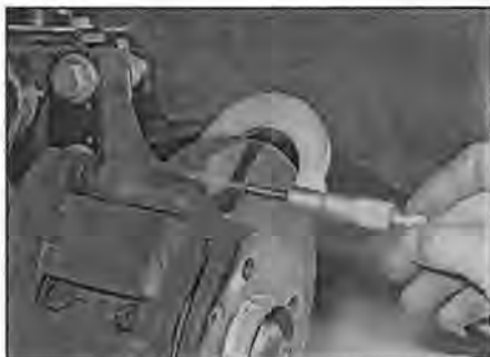
Рис. 6.3 Измерение микрометром толщины тормозного диска
