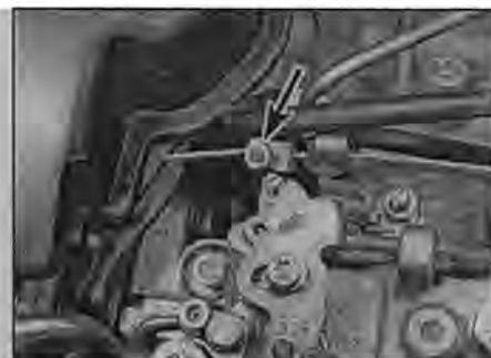
Рис. 10.3 Наконечник троса термостатического актюатора пусковых оборотов
