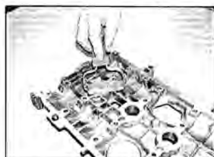
Рис. 8.46 Нанесите роликом герметик на стыковочную поверхность клапанной крышки
