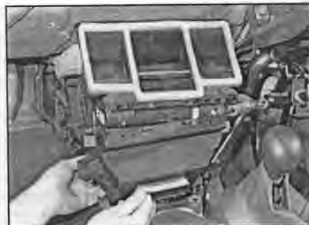
Рис. 9.41 ... и снимите нижний воздуховод и корпус с автомобиля
