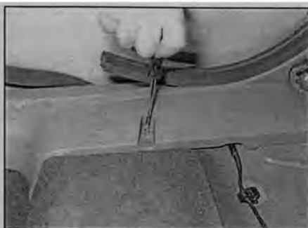
Рис. 27.8 Если требуется, отверните винт крепления, чтобы можно было оттянуть боковую накладку достаточно для доступа к заднему винту крепления передней панели
