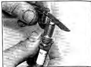
Рис. 19.12, б. ... и плоским щупом
