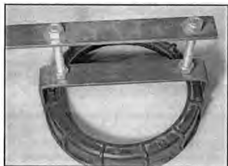
Рис. 8.6,а. Самодельный инструмент для отворачивания запорного кольца
