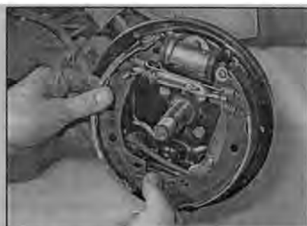
Рис. 5.8 Выведите колодку из нижнего упора и отцепите нижнюю стяжную пружину
