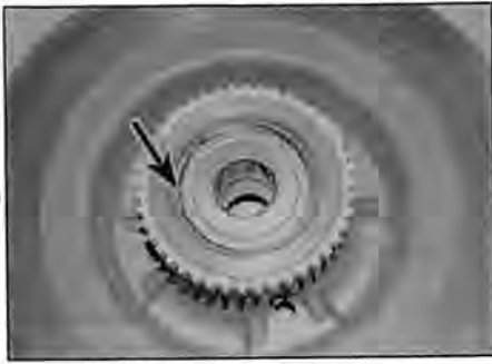
Рис. 9.11 Стопорное кольцо подшипника задней ступицы (указано стрелкой)
