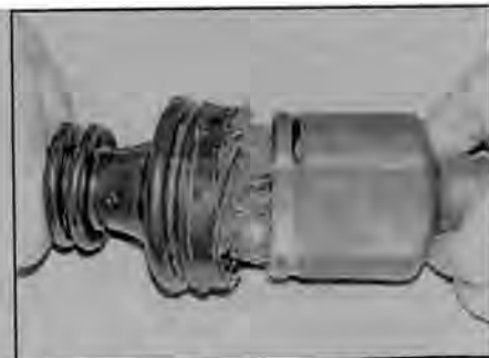
Рис. 4.14,б. ... и совместите половинки шарнира
