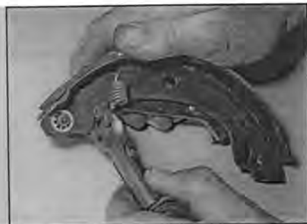
Рис. 5.10,в. Отцепите регулировочную стойку от задней колодки...
