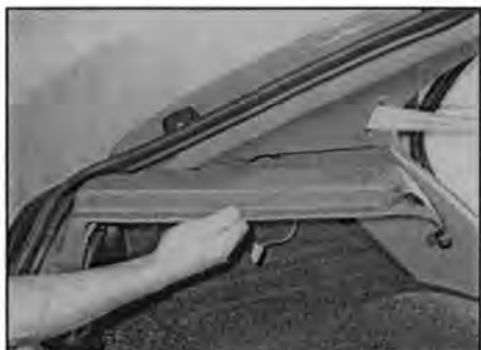
Рис. 27.39, б. ... и снимите боковую панель полки
