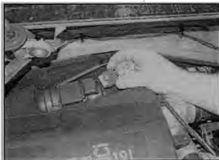
Рис. 2.11,а. Отсоедините от ДМРВ проводку
