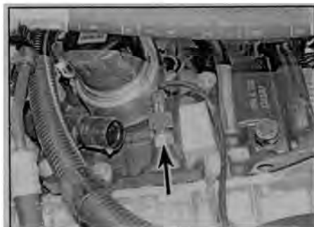
Рис. 14.1 Датчик аварийного давления масла расположен под масляным фильтром
