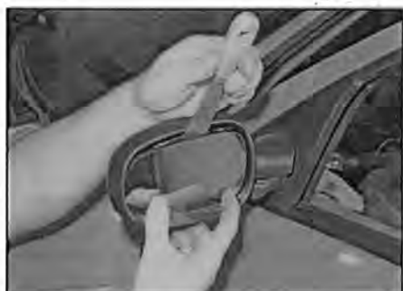
Рис. 21.17 Аккуратно снимите стекло зеркала
