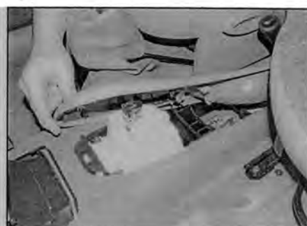
Рис. 29.9 Освободите крышку от центральной консоли
