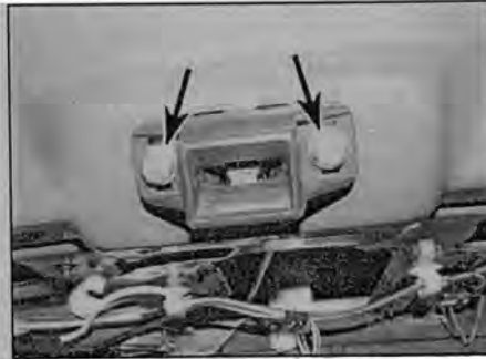
Рис. 18.4 ...отверните болты крепления и снимите замок
