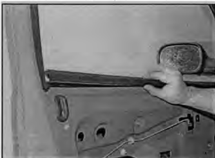
Рис. 14.4 На моделях хэтчбек и седан открепите внутренний уплотнитель стекла и снимите его с двери
