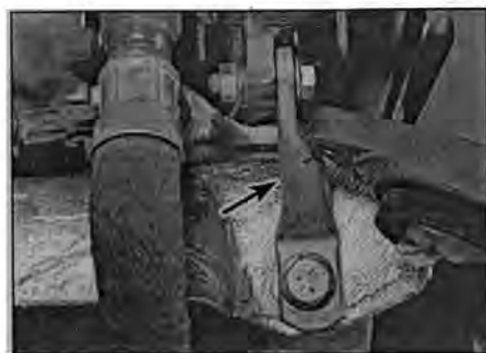
Рис. 30.6,б. Нижний кронштейн подержки турбоагнетателя (указан стрелкой) – вид при снятом двигателе (ранние модели)
