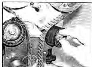
Рис. 3.20 Отверните болт и снимите паразитный ролик ремня ГРМ и втулку
