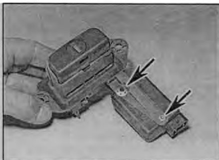
Рис. 19.7 Винт крепления и фиксатор (указаны стрелками) – модели купе
