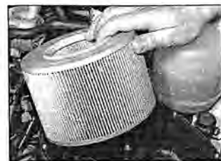
Рис. 19.2 Снимите фильтрующий элемент – модели без турбонаддува
