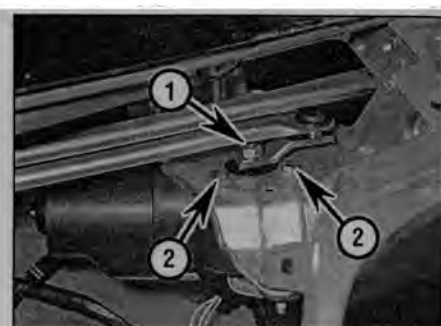
Рис. 16.4 Отверните гайку шпинделя (1), отверните болты крепления (2) – один не виден – и снимите мотор
