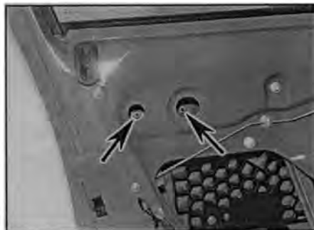
Рис. 13.4,а. Отверните гайки крепления (указаны стрелками)....
