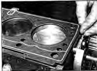
Рис. 9.84 Уложите новую прокладку блока цилиндров на блок, совместив ее с направляющими втулками
