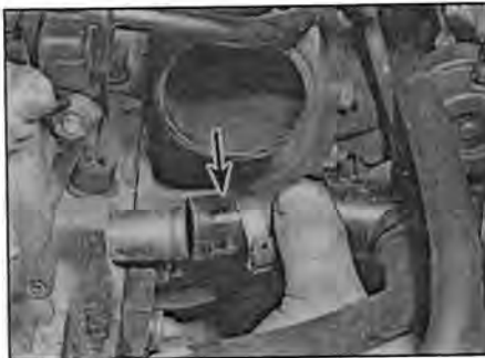
Рис. 30.16 Отсоедините шланг охлаждения (указан стрелкой) от задней части головки цилиндров
