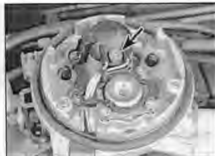
Рис. 13.7 Винт крепления крышки датчика температуры воздуха на впуске (двигатель Е7J)
