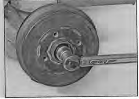
Рис. 7.15,б. ...и затяните ее предписанным моментом
