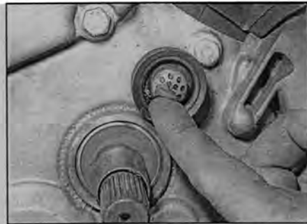
Рис. 5.5 Перед установкой вилки смажьте шарнир опорной стойки молибдендисульфидной смазкой
