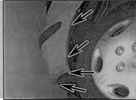
Рис. 7.2 Отверните винты крепления (указаны стрелками) локеров к заднему бамперу
