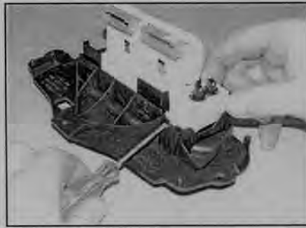
Рис. 11.3 Открепите от дисплея блок аварийной сигнализации
