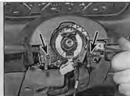
Рис. 25.18,б. Отверните винты крепления (указаны стрелками) и снимите верхнюю половину
