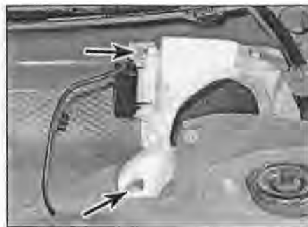
Рис. 9.48 Отверните две гайки (указаны стрелками) и снимите узел клапана рециркуляции с автомобиля
