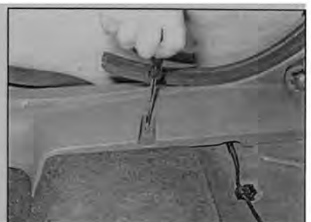
Рис. 27.28 Отверните болт верхнего крепления ремня
