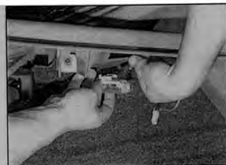
Рис. 6.10 На моделях хэтчбек снимите фонарь освещения багажного отделения и отсоедините проводку
