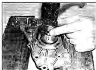
Рис. 12.5 С помощью головки запрессуют новый сальник в корпус
