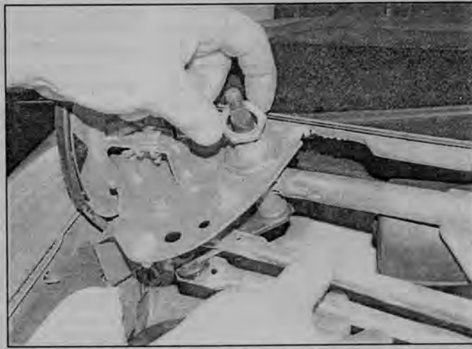
Рис. 16.17,б. Снимите резиновые заглушки, отверните гайки шпинделя (указана стрелкой) и снимите шайбы - Scenic
