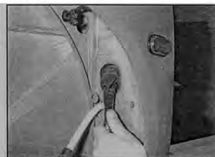
Рис. 30.8,е. ... и освободите уплотнитель так, чтобы проводку можно было вытянуть при снятии лицевой панели
