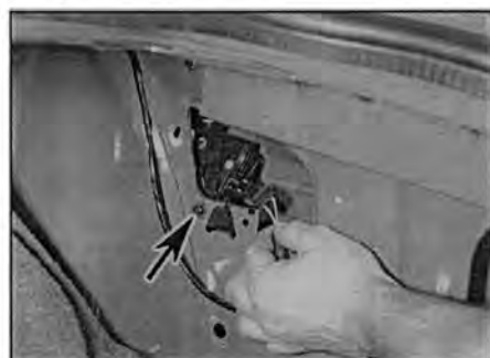
Рис. 19.12 Отсоедините разъем проводки лючка и отверните винт (указан стрелкой)...
