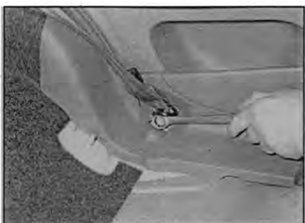
Рис. 27.14 Отверните болт нижнего крепления ремня
