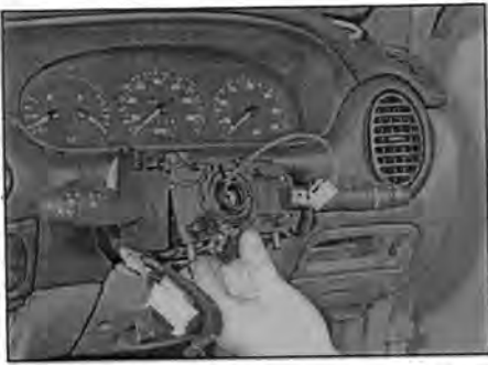
Рис. 4.11 Снятие узла подрулевого переключателя полностью
