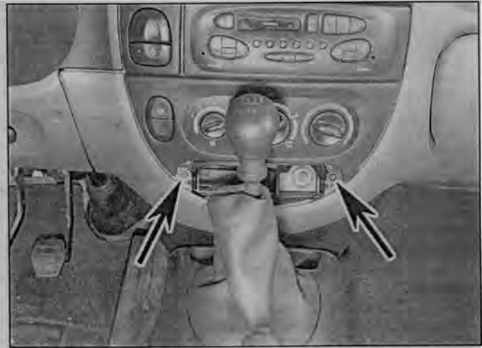
Рис. 12.2,б. ... отверните винты крепления пепельницы (указаны стрелками)
