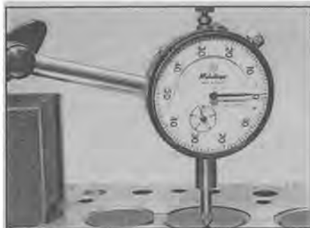
Рис. 9.9,а. Измерение заглупления клапана...
