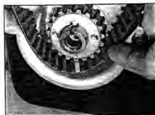
Рис. 5.29,а. Совместите метки на ремне и звездочке коленвала
