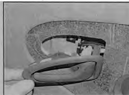
Рис. 12.13,б. ... и отцепите трос управления
