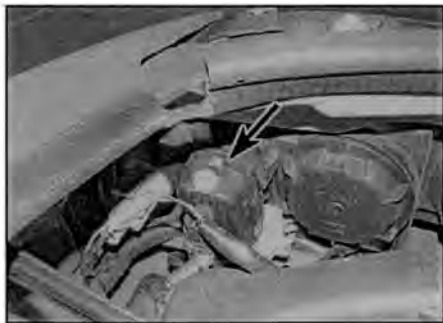
Рис. 8.2 Мотор корректора фары – стрелкой указан регулировочный винт
