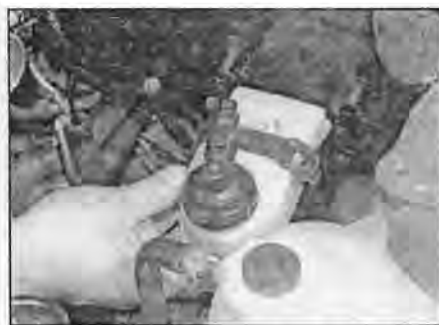
Рис. 9.23 Отверните гайки крепления и снимите бачок главного тормозного цилиндра с моторного щита
