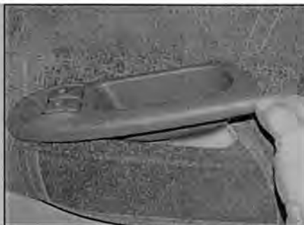
Рис. 4.30,б. ... и открепите узел от панели обивки
