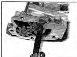
Рис. 11.11,а. Измерение зазора корпус/шестерня
