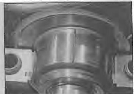
Рис. 19.7 Отрезок Plastigauge уложен на пятую шейку
