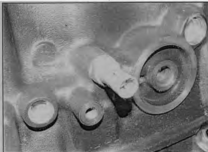
Рис. 13.4 Датчик аварийного давления масла (фильтр снят)
