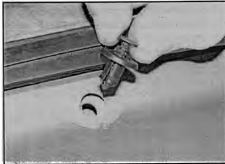
Рис. 7.1,г. ... снимите пластиковые клипсы (модели Scenic)
