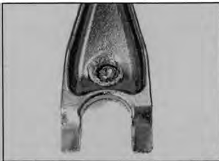
Рис. 5.3,в. Ответная выемка на вилке для установки на шарнирной стойке
