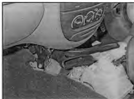
Рис. 30.7,г. ... и открепите воздуховод от лицевой панели
