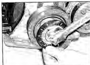
Рис. 3.57 Окончательная затяжка болта доворачиванием на предписанный для стадии 2 угол
