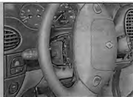
Рис. 4.10 Отверните винты крепления и снимите подрулевой переключатель с кронштейна
