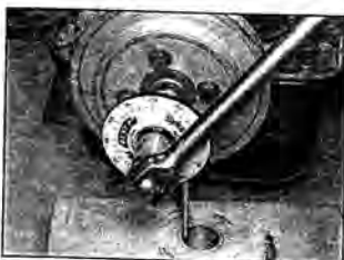
Рис. 5.33 Доворот болта шкива коленвала с помощью угломерного инструмента
