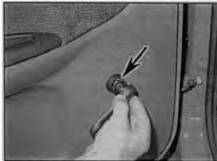
Рис. 12.7 На моделях с механическими стеклоподъемниками открепите рукоятку и снимите шайбу (указана стрелкой)
