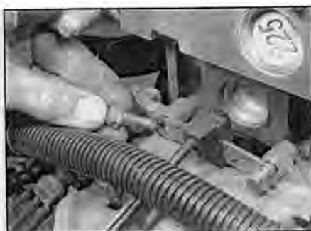
Рис. 14.48 Обратите внимание на конфигурацию болтов крепления датчика положения коленвала
