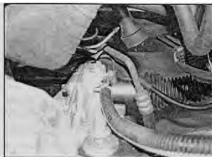
Рис. 8.20 Крепление шины "массы" к КПП
