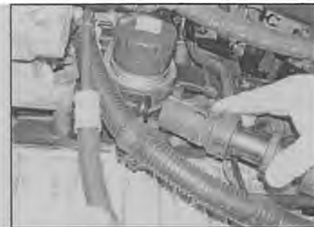
Рис. 6.64,б. Отсоедините нижний шланг радиатора от входной трубки водяного насоса
