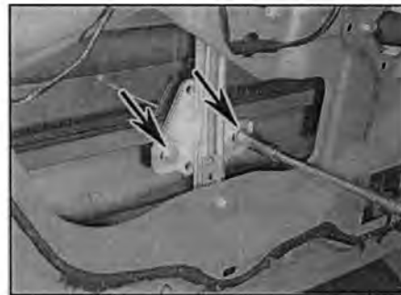
Рис. 14.24 Отверните болты крепления (указаны стрелками) и освободите стекло от стеклоподъемника
