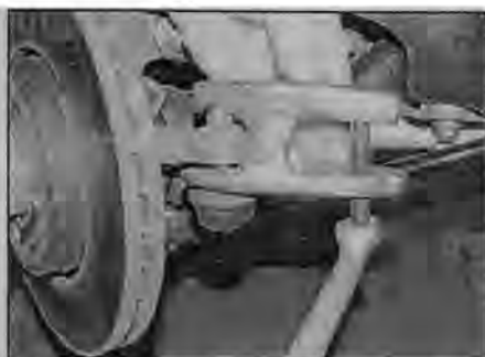
Рис. 21.4 Применение съемника для снятия рулевого наконечника
