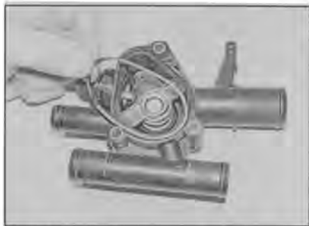
Рис. 10.7 Устанавливая корпус термостата установите новое уплотнительное кольцо
