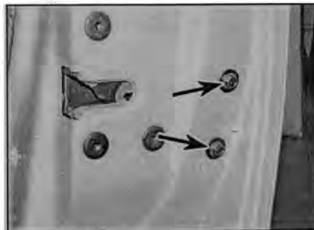
Рис. 13.7,б. Отверните два винта (указаны стрелками) ...
