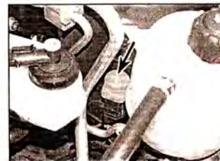
E Проверьте надежность электрических соединений электромагнитного клапана отсечки топлива
