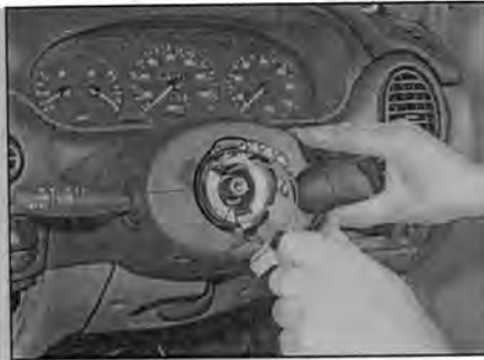
Рис. 4.12 Если снимается весь узел переключателя, совместите его рычаги с отверстиями в кожухе и затяните стяжной винт хомута.
