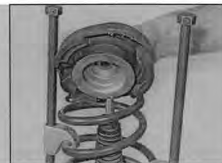
Рис. 5.10 При установке верхней опоры проследите, чтобы конец пружины упирался в выемку опоры
