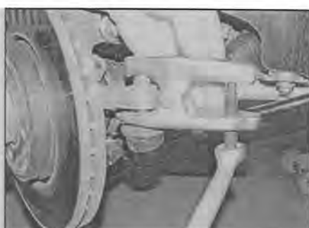
Рис. 6.81,б. ... и отсоедините съемником рулевой наконечник
