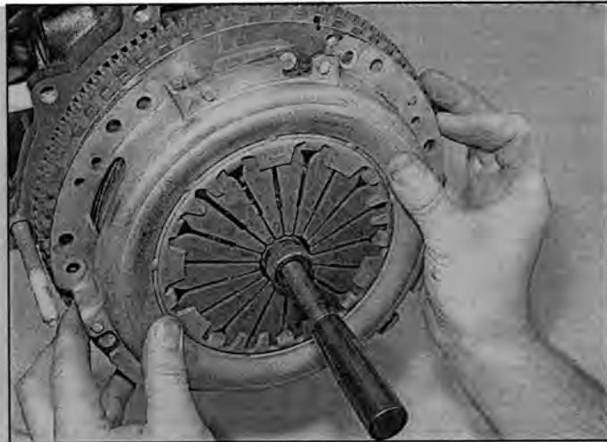
Рис. 4.14 Установка комплекта сцепления
