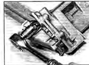
Рис. 11.10.а. Отверните болты крепления крышки и маслоприемника к масляному насосу
