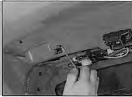
Рис. 4.44,а. Поддев отверткой, снимите выключатель освещения перчаточного ящика...
