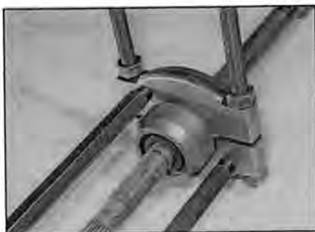
Рис. 3.15 Снятие с приводного вала демпфера (если предусмотрен)
