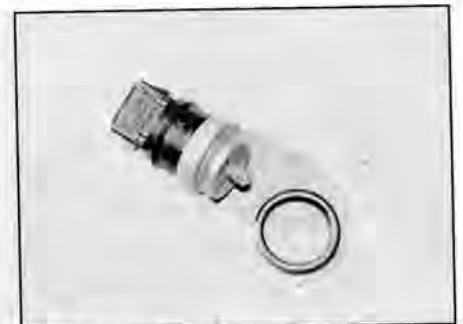
Рис. 6.18 ... и установите новое уплотнительное кольцо – дизель F9Q
