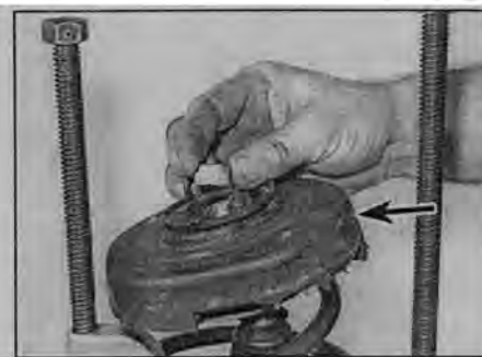
Рис. 5.3 Отверните гайку и снимите верхнюю опору (указана стрелкой)
