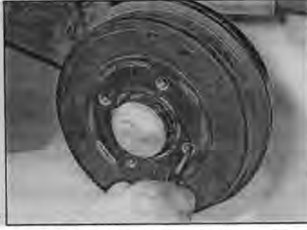
Рис. 7.6,а. Отверткой через болтовое отверстие ослабьте рабочий рычаг ручного тормоза...
