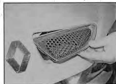
Рис. 8.8,б. и снимите решетку с капота
