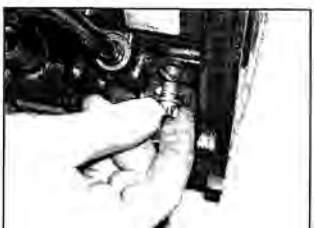
Рис. 3.15.а Выверните пробку из отверстия в передней части левой стенки блока цилиндров...
