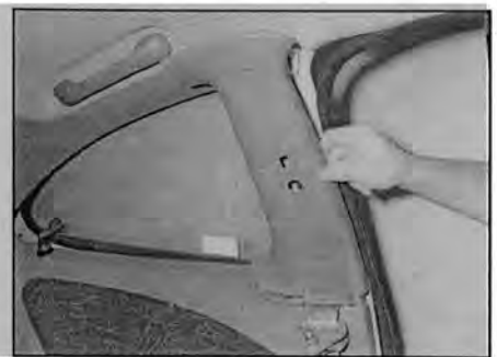
Рис. 27.19 Открепите накладку стойки и снимите ее
