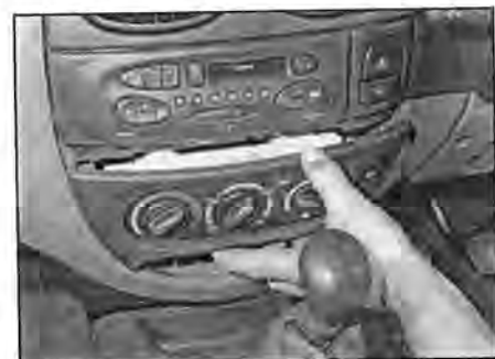
Рис. 9.3 Открепите панель управления от лицевой панели...
