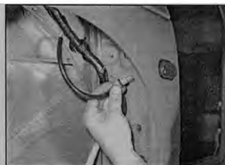
Рис. 30.8,д. ... отсоедините патрончик от повторителя...
