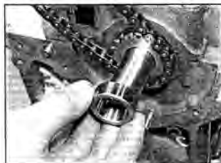
Рис. 11.7 снимите проставку сальника
