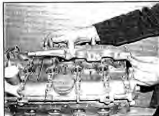
Рис. 8.31 Отверните восемь болтов и снимите корпус маслоотделителя
