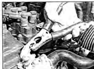
4 Другой конец черного провода соедините с каким-нибудь кронштейном двигателя, который необходимо завести, подальше от аккумулятора.
