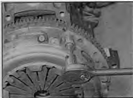
Рис. 4.3,а Равномерно ослабьте болты крепления корзины, заблокировав отверткой маховик от проворачивания...
