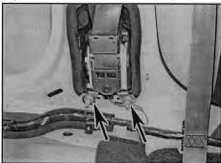
Рис. 27.24 Гайки крепления (указаны стрелками) инерционной катушки переднего сиденья – модели купе
