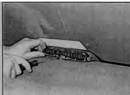
Рис. 7.27,а. На моделях седан освободите фиксаторы...
