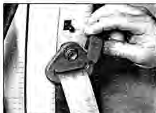
Рис. 17.3 Проверьте надежность крепления ремней безопасности
