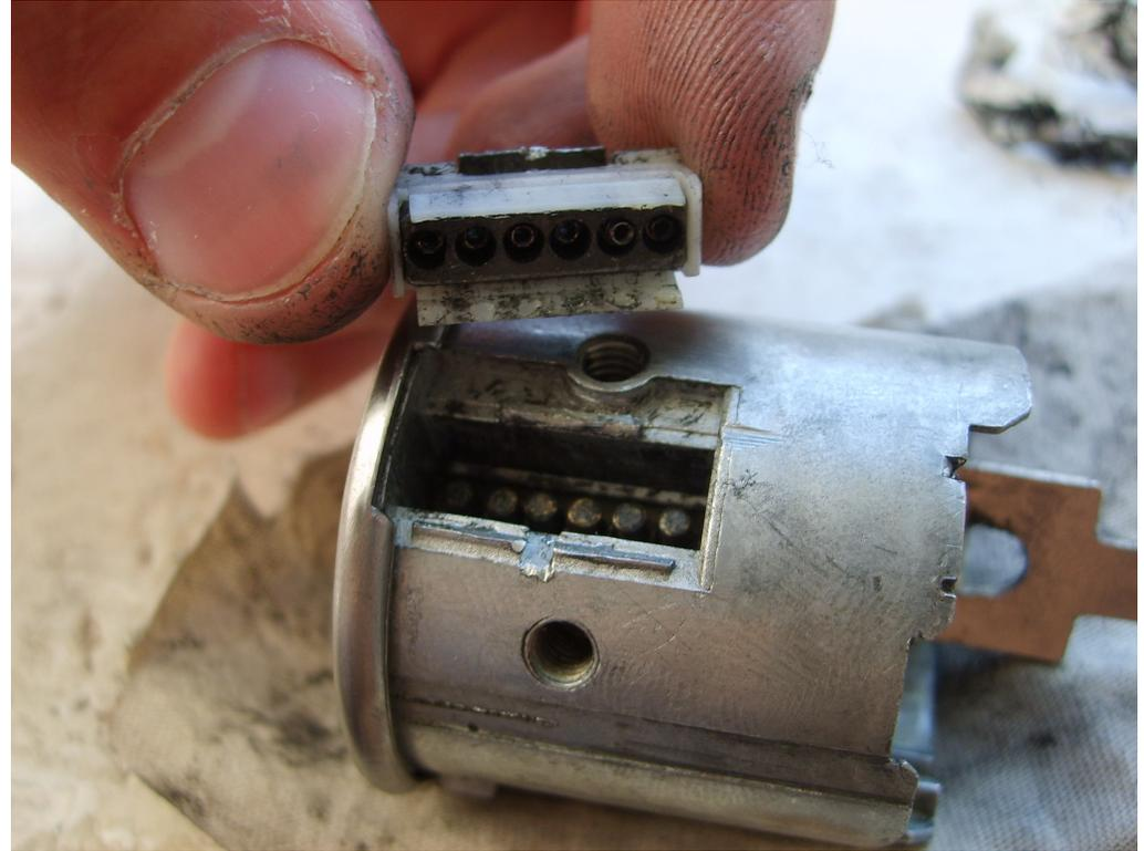
**Примечание:** крышку желательно чем-нибудь закрепить, например клеем, но после того, как полностью соберёте механическую часть замка и проверите его работоспособность.
