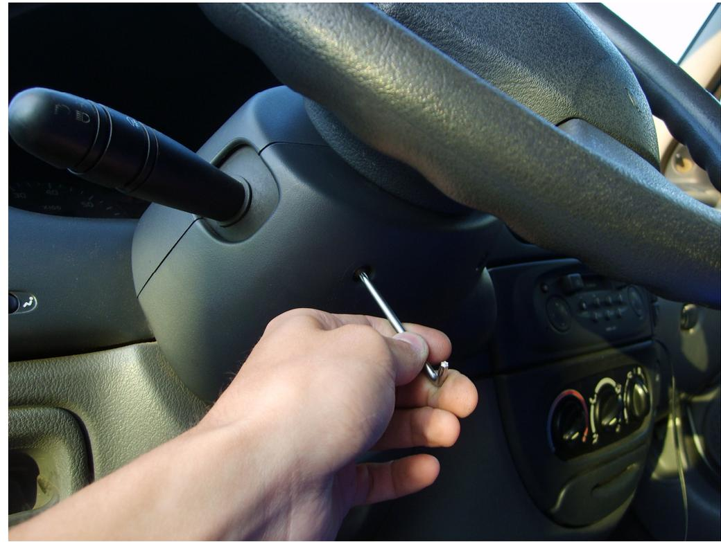
3. Откручиваем два шурупа крепящих верхнюю часть панели рулевой колонки и снимаем её.
