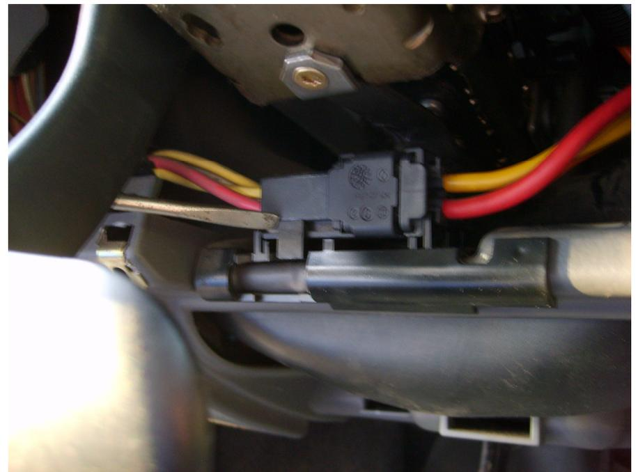
10. Вставляем ключ в замок и поворачиваем до положения между метками А и М, отвёрткой утапливаем фиксатор и вынимаем корпус замка. Провода перед этим выньте наружу.
