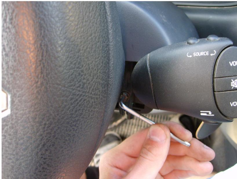
4. Откручиваем два шурупа крепящих крышку возле рычага регулировки положения руля и снимаем её.
