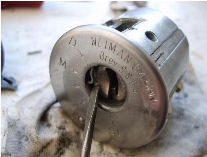
18. Утапливаем пальчики внутренней части на сколько это возможно, сверху ставим пальчики которые вынимали по порядку согласно с пунктом 16 и закрываем крышкой.
