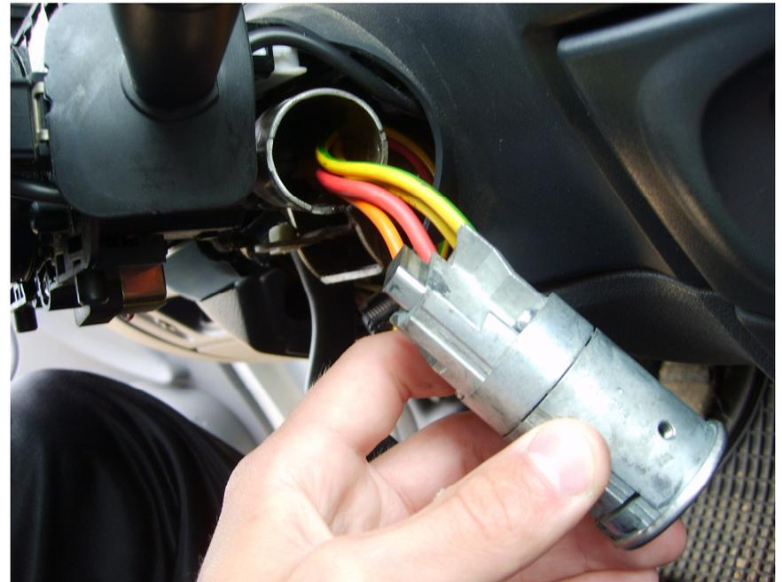
11. Откручиваем два винта в корпусе замка и снимаем механическую часть замка, электрическую часть (та которая в пластмассовом корпусе) оставляем как есть (если конечно не в ней поломка).
