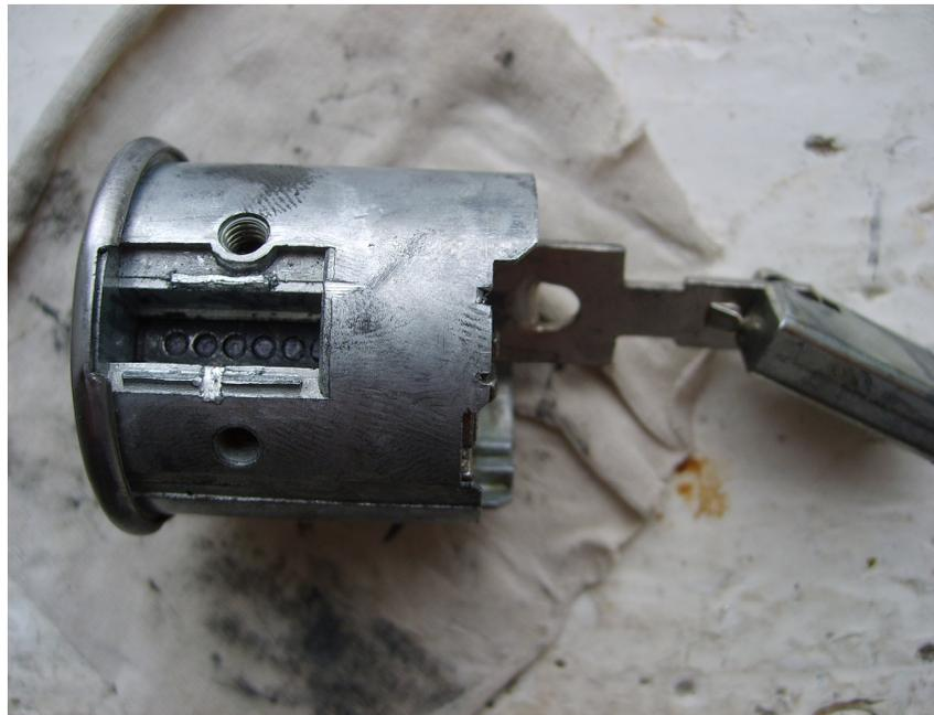
15. Вытаскиваем внутреннюю часть и вынимаем всё остальное.
