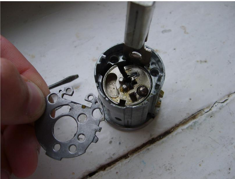
13. Снимите шарик и пружинку под ним. Вставьте отвёртку или что-нибудь тонкое туда, куда вставляется ключ и с другой стороны выньте ещё две детали.
