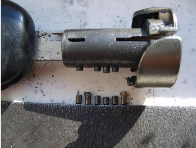
17. Ставим на место внутреннюю часть вместе с блокиратором руля и его пружиной. Отжимаем пружину, та которая на рисунке и засовываем внутреннюю часть до конца.
