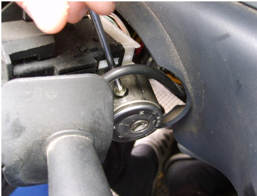
9. Желательно снять оплётку проводов идущих к замку зажигания а также штекер.
