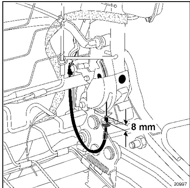
При установке троса механизма откидывания спинки необходимо обеспечить регулировку с использованием стопорных шайб (8 мм).
