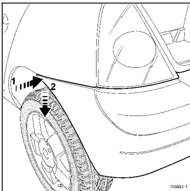
Отсоедините угол бампера (1), затем наклоните бампер (2).
