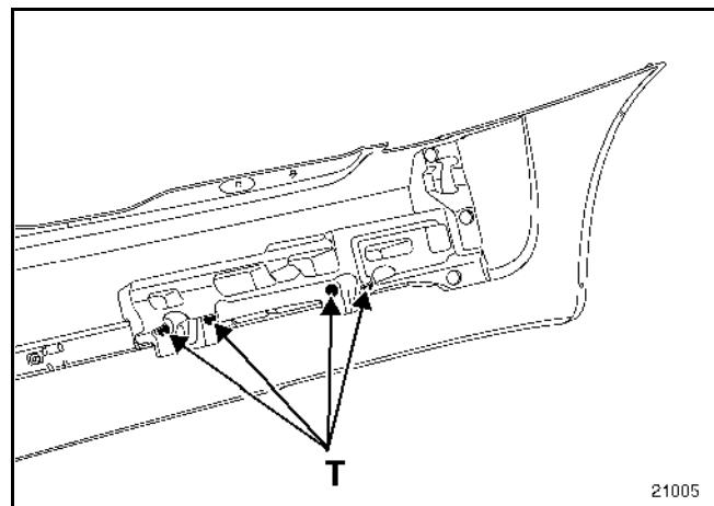
Удалите фиксаторы (T), затем отсоедините абсорбер.
