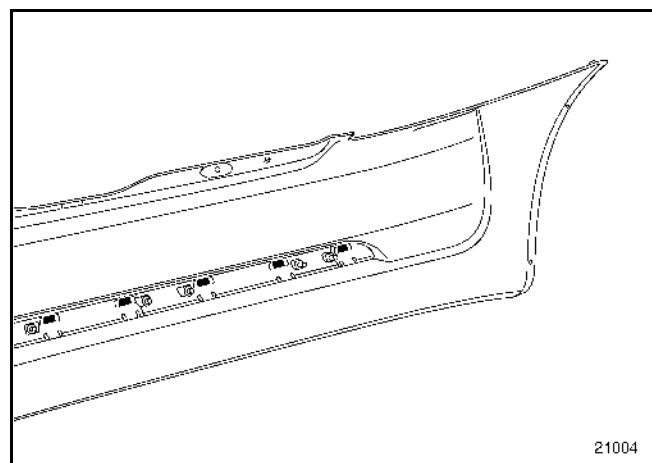
Отсоедините фиксаторы, затем снимите планку.
