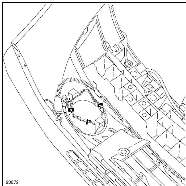
Снимите три держателя, затем снимите кронштейн противотуманной фары.
