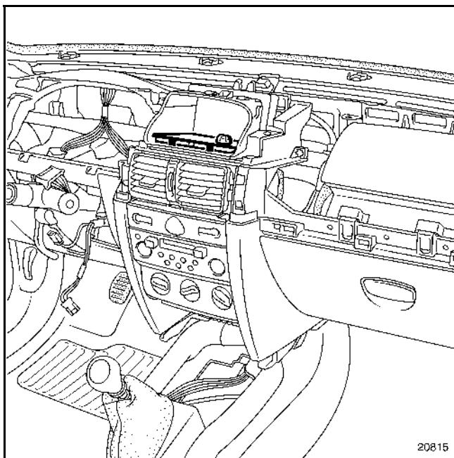
С помощью приспособления (**Car. 1597**) отожмите пружинные фиксаторы и извлеките клавиатуру навигационной аппаратуры Carminat или отделение для мелких предметов (в зависимости от комплектации).
