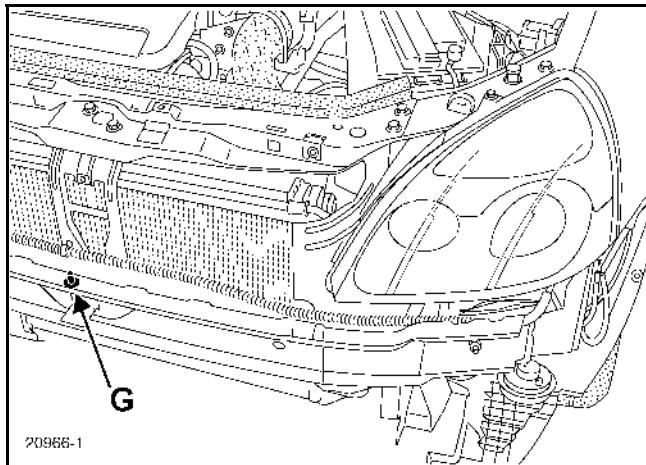
Перед началом установки бампера убедитесь в наличии центрирующей направляющей (G), обеспечивающей правильное расположение бампера.
