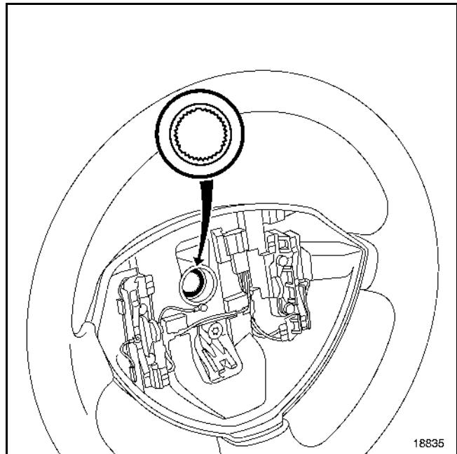
**ВАЖНО!** Шлицы ступицы рулевого колеса имеют специальные устройства, защищающие от неправильного соединения. Рулевое колесо должно свободно надеваться на шлицы рулевой колонки.
