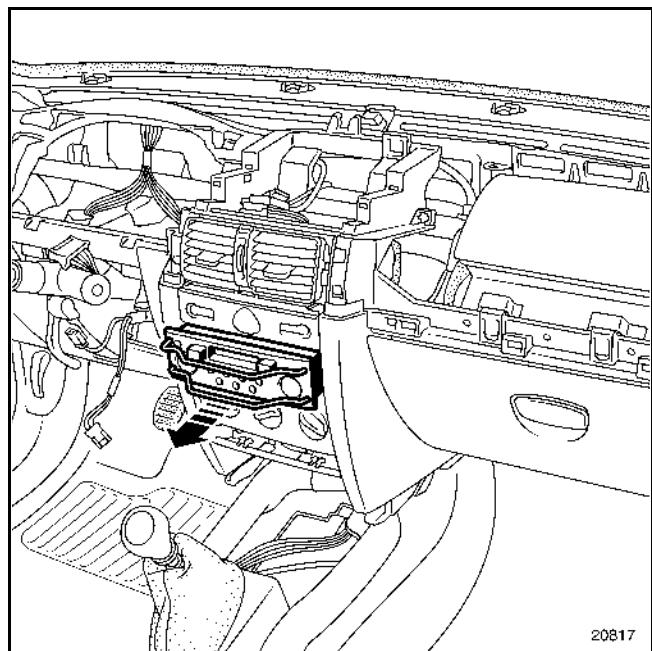
С помощью приспособления (**MJ.1373**) снимите автомагнитолу.
