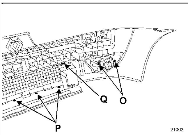
Отверните два крепежных болта (O), разъедините разъем, затем отсоедините противотуманную фару.
