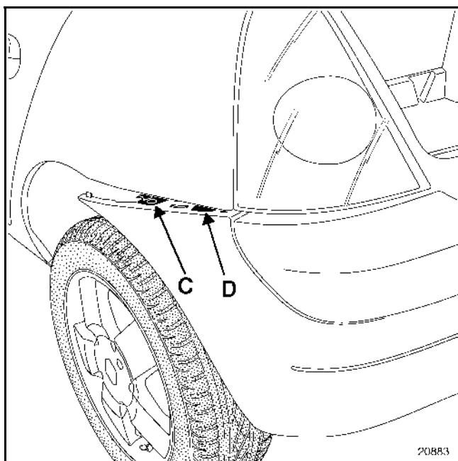
Защитите кант заднего крыла под порогом кузова.
