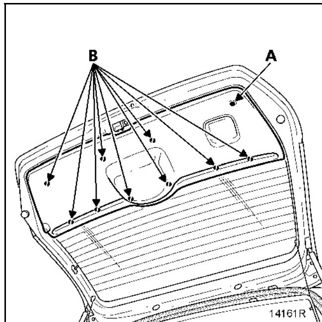
Отверните крепежный болт (A).
