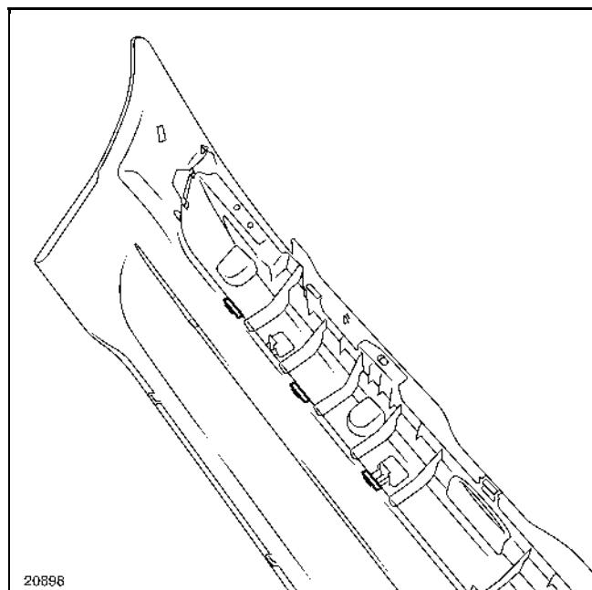
Отсоедините крепления направляющего выступа, затем вытяните его.
