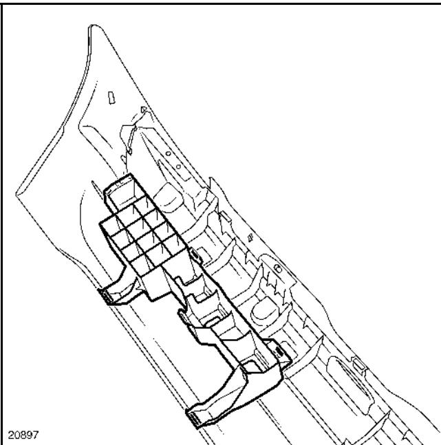
При помощи плоской отвертки отсоедините четыре крепления, затем снимите абсорбер.
