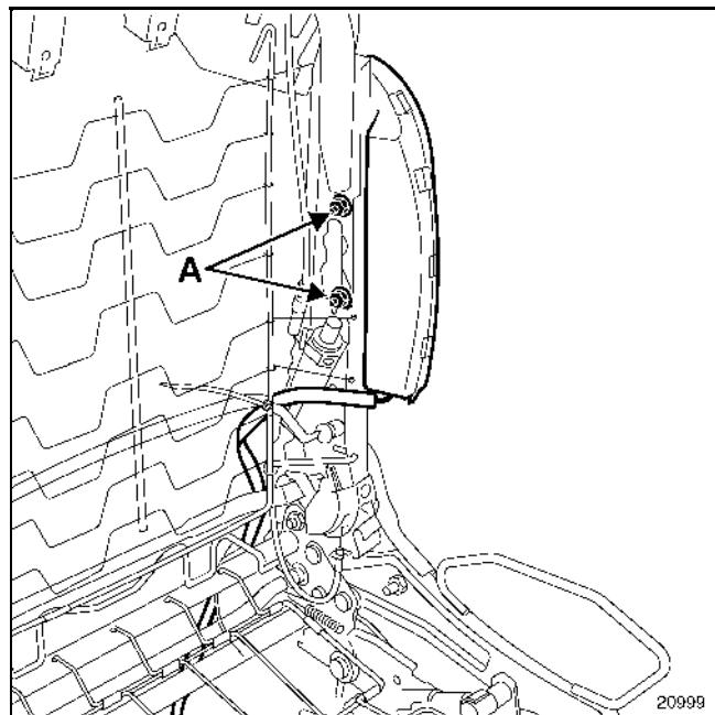
Удалите два крепления (A), затем частично отсоедините подушку безопасности.
