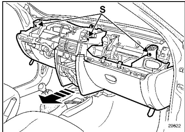
Отверните три верхних винта (S) крепления приборной панели.
