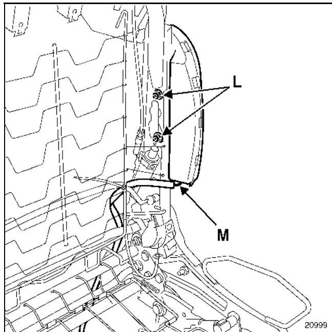
Затяните две гайки крепления подушки безопасности (L) моментом (8 Нм).
