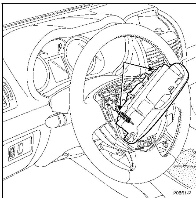
Разъедините два разъема питания газогенераторов.
