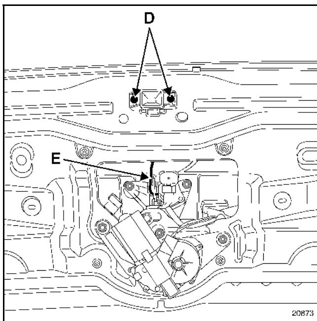
Выверните два винта крепления замка (D).
