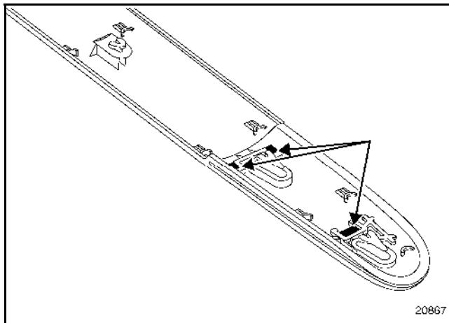
При помощи небольшой отвертки отсоедините три фиксатора, затем снимите заводской знак.
