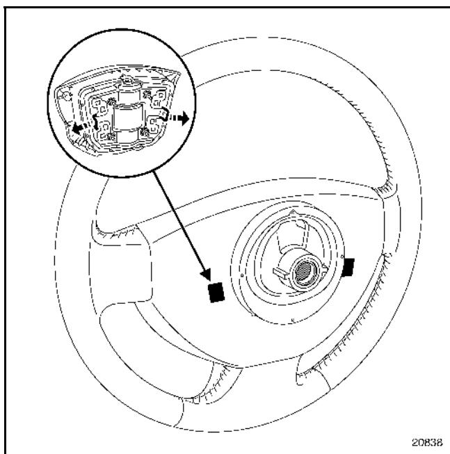
С помощью отвертки с плоским лезвием снимите подушку безопасности с рулевого колеса, отжав пружинные фиксаторы.
