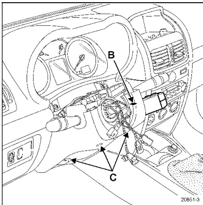
Нажмите плоской отверткой на фиксатор (B), чтобы извлечь пульт дистанционного управления автомагнитолой.
