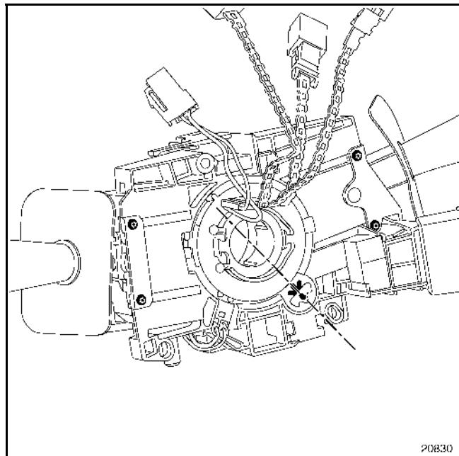
Проверьте правильность установки контактного диска: метка "О" должна совпадать с плоскостью оси рулевой колонки.
