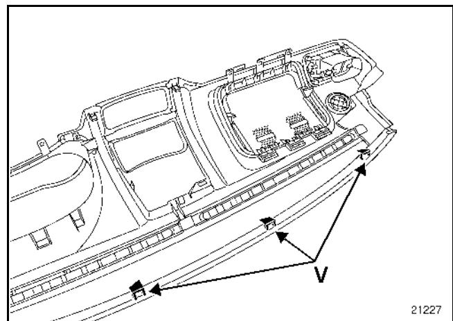
**ВАЖНО!** Перед установкой накладки необходимо проверить состояние фиксаторов (U) и (V).
