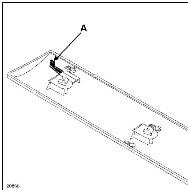
Перед установкой накладок необходимо немного вытащить фиксатор (A), чтобы обеспечить блокировку накладки.
