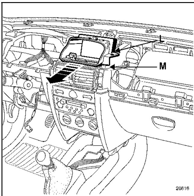
Отверните два винта (L).
