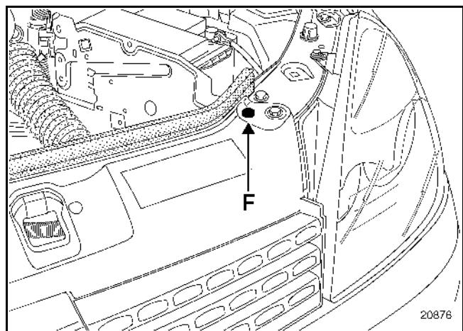
Снимите два пружинных фиксатора (F).
