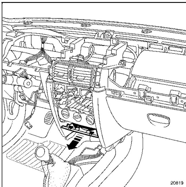
Снимите кронштейн крепления громкоговорителя навигационной системы Carminat и разъедините разъем.
