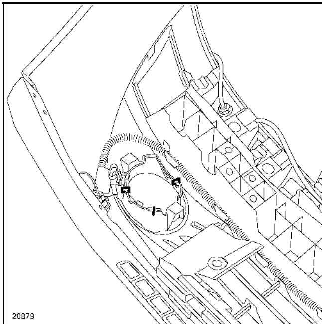
При помощи приспособления (Car. 1521) зафиксируйте кронштейн противотуманной фары на бампере (держатель с тупым концом).
