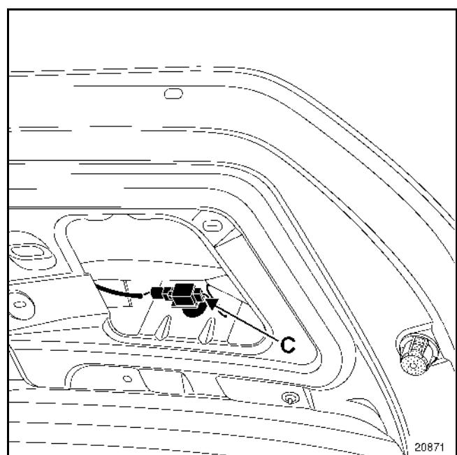
Отсоедините штекерную часть разъема (C), затем вытащите розеточную часть разъема из держателя.
