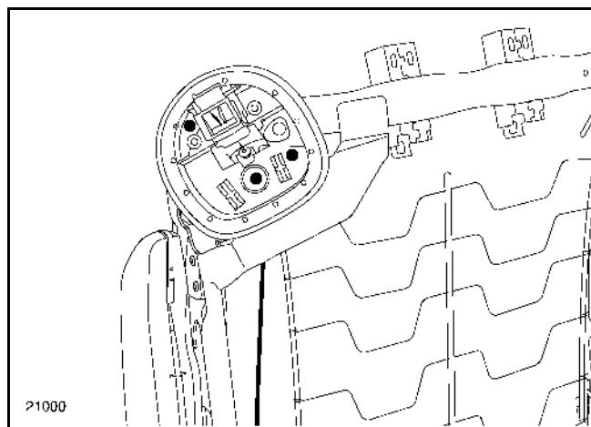
Высверлите три заклепки, затем отсоедините механизм отпирания.
