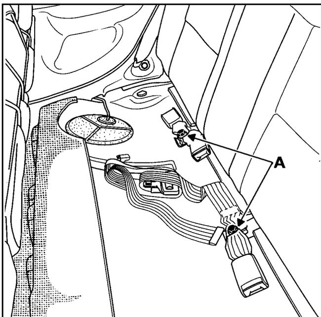
Снимите два болта крепления каркаса спинки сиденья (A).
