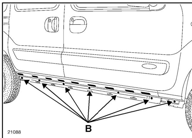
Отверните гайки (B), затем снимите кронштейны нижней секции боковины кузова.
