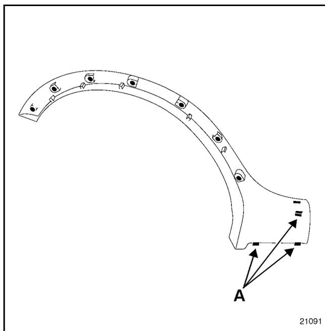
Снимите три пружинные держатели (A), затем снимите расширитель.
