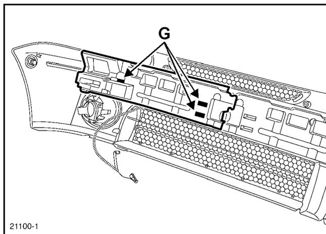
Снимите пружинные держатели (G), затем снимите демпфер.
