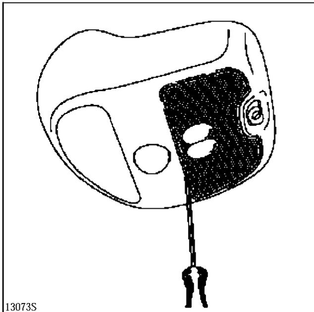
Отожмите пружинные защелки наружной части.
