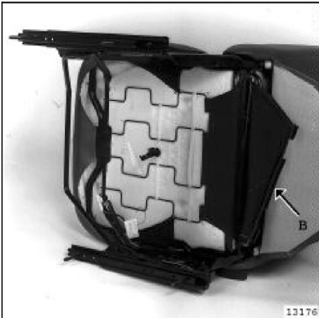
Отожмите пружинные защелки заднего края обивки (В).
