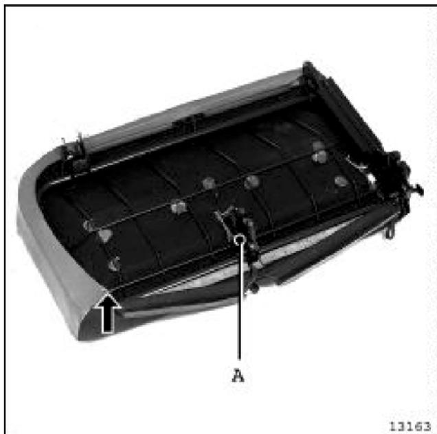
Отверните болт (А) крепления ремня безопасности.
