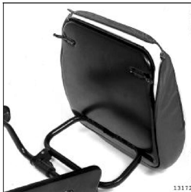
Отожмите пружинные защелки по краям обивки.
