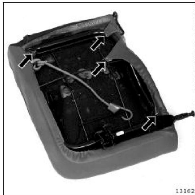
Отжав пружинные защелки, отсоедините задний край обивки.
