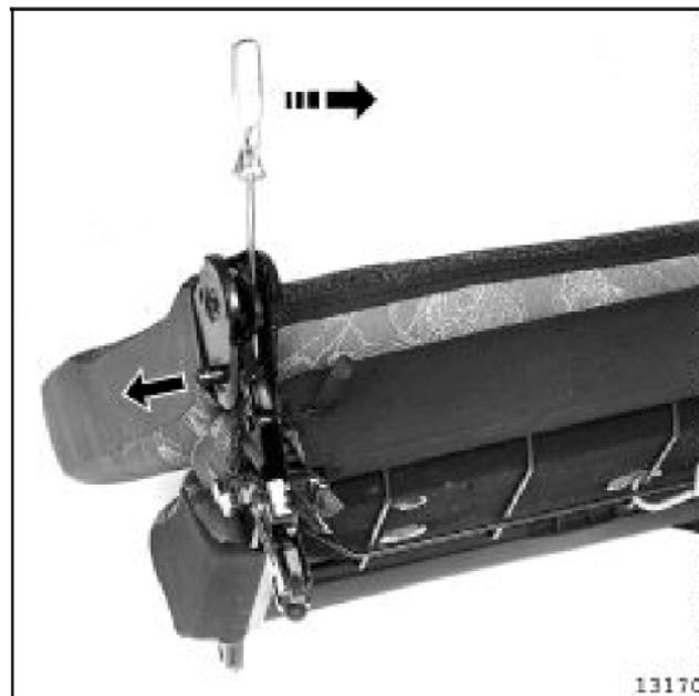
Снимите детали крепления спинки сиденья и дистанционные втулки.
