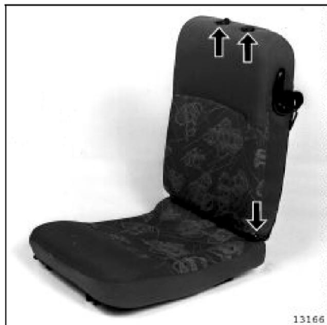
Снимите детали крепления спинки сиденья и верхние части направляющей подголовника.
