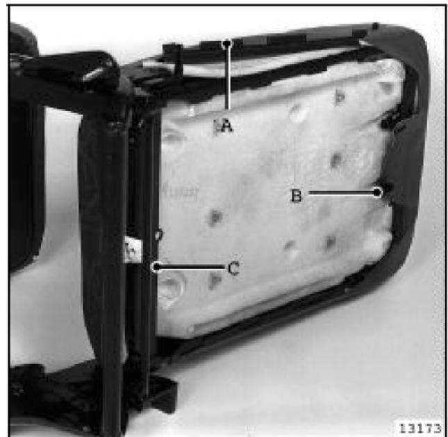
Отожмите пружинные защелки обивки в точках (A), (B), (C).
