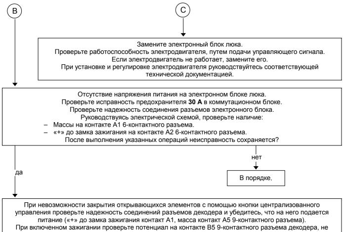
При включенном зажигании проверьте потенциал на контакт В 9-контактного разъема декодера, не отключая разъем (доступ к указанному разъему обеспечивается при снятии вентиляционной решетки). Если напряжение выше или ниже 12 В, замените декодер.
