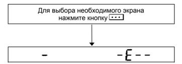
Обнаружение неисправности датчика температуры охлаждающей жидкости.
