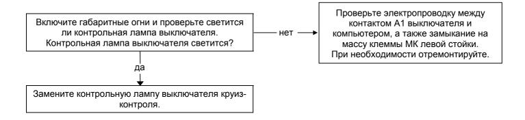
АЛГОРИТМ ПОИСКА НЕИСПРАВНОСТЕЙ 5: Система круиз-контроля не отключается при нажатии на педаль сцепления
