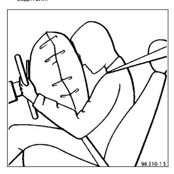
**ПРИМЕЧАНИЕ:** Данные системы готовы к срабатыванию только при включенном зажигании. В нижнем углу ветрового стекла автомобиля, оборудованного подушкой безопасности, со стороны водителя имеется специальная наклейка, а также надпись «air bag» в центре рулевого колеса.
