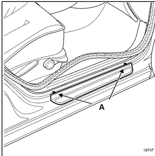
Отцентрируйте защитную накладку, выровнявая две метки (А) по двум отверстиям для стока воды на панели порога.
