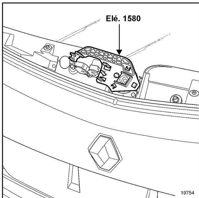
Закрепите шаблон со щелчком на пластине электродвигателя (С).
