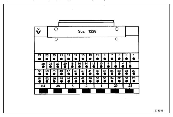
Контактная плата **Sus. 1228** представляет собой 55-контактную плату, которая имеет встроенную печатную плату с 55-ю медными контактными площадками, пронумерованными от 1 до 55.
