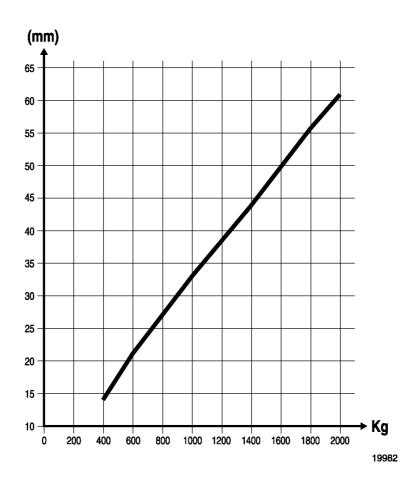
Нагрузка на заднюю ось/деформация шины (давление 1,5 бар)
