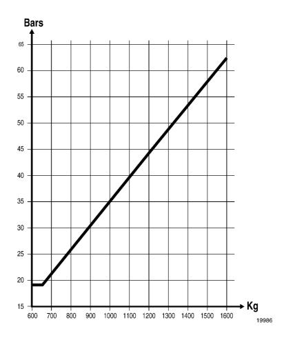
Регулировка выходного давления ограничителя тормозных сил/ нагрузка на заднюю ось
