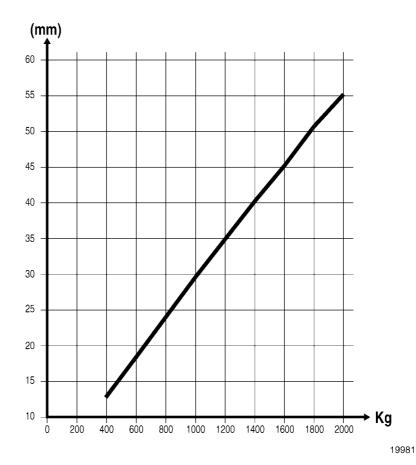
Нагрузка на заднюю ось/деформация шины (давление 1,5 бар)
