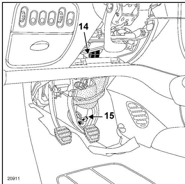
Снимите датчик угла поворота рулевого колеса, отжав фиксаторы.
