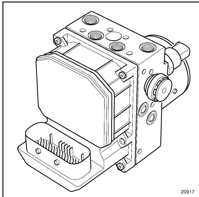
Гидравлический блок располагается в правой передней части автомобиля за передним бампером.
