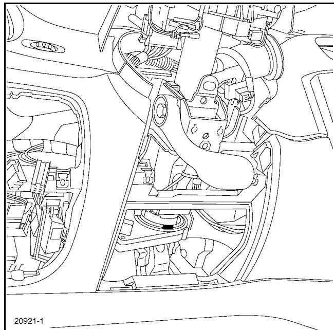
Внимание! Датчик снабжен тремя фиксаторами. Чтобы получить доступ к фиксаторам с задней стороны, необходимо повернуть рулевую колонку.
