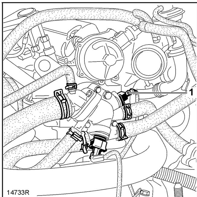
Датчик температуры охлаждающей жидкости (1) (для передачи сигнала на ЭБУ системы впрыска и указатель температуры охлаждающей жидкости на щитке приборов используется один трехконтактный датчик).
