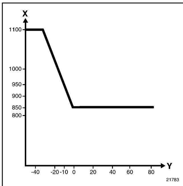
X: Частота вращения коленчатого вала двигателя,
