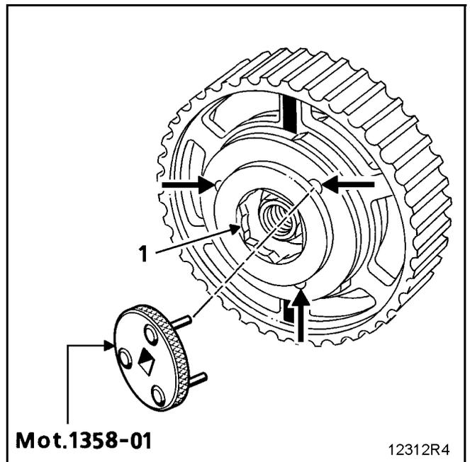
Повернуть вместе фланец и приспособление **Mot. 1358-01** по часовой стрелке до упора шкива, при этом шкив занимает положение начала регулировки.
