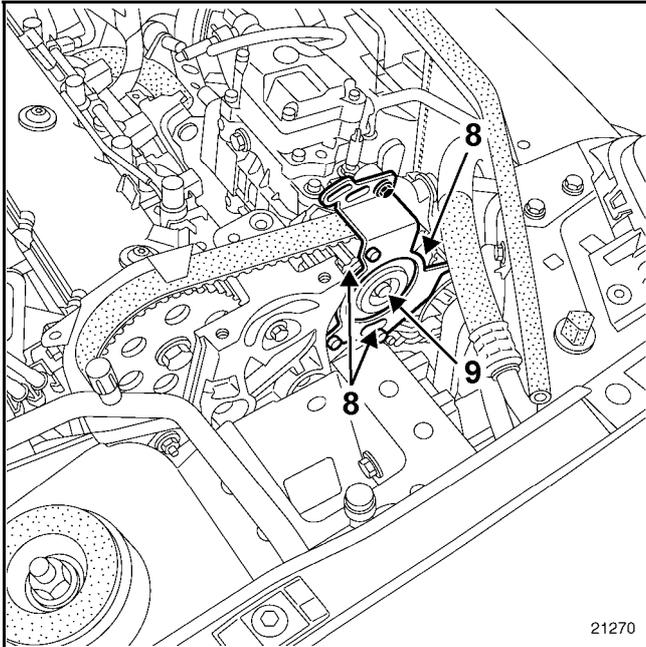
Снимите ТНВД, отворачивая поочередно центральную гайку насоса и три болта крепления насоса.
